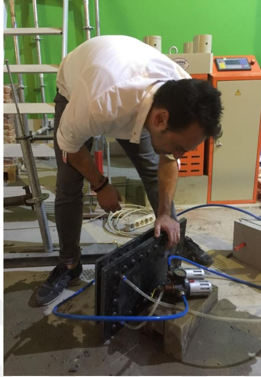
Resim 4.31 : Test Aşaması (3 bar 10 dakika).
