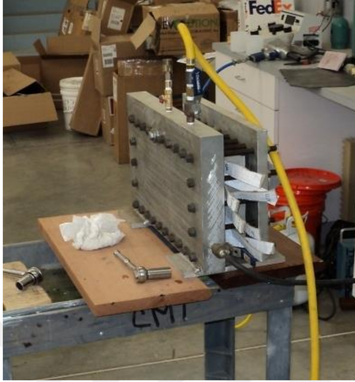
Resim 4.13 : Yatayda Su Yürütme Test Düzeneği (ASTM D 5385 Modifiye).
