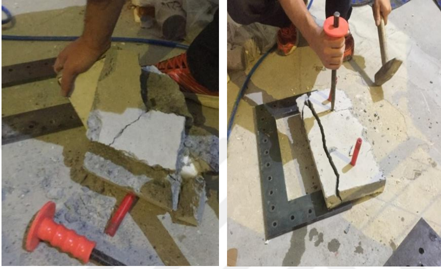
Resim 4.35 : Test Sonrası Deney Numunesinin Kırılması-1.
