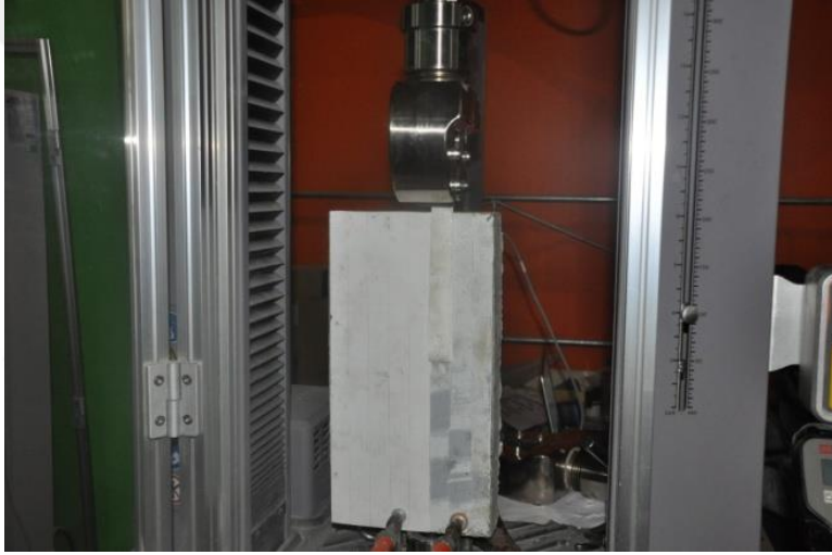
Resim 4.39 : Sıyırılma Test Aşaması-1.
