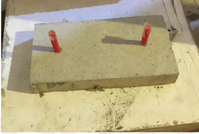
Resim 4.20 : Prizini Alan Numunenin Kalıptan Çıkarılması.
