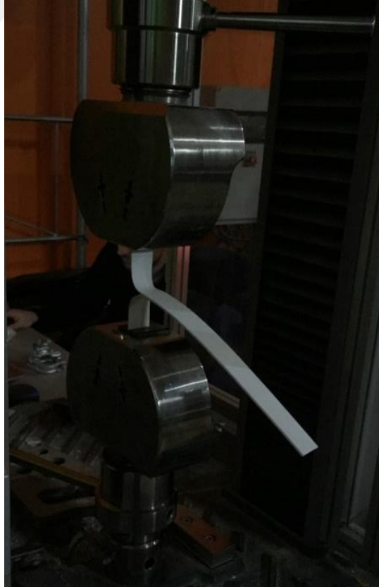
Resim 4.53 : Yapışma Test Aşaması-1.
