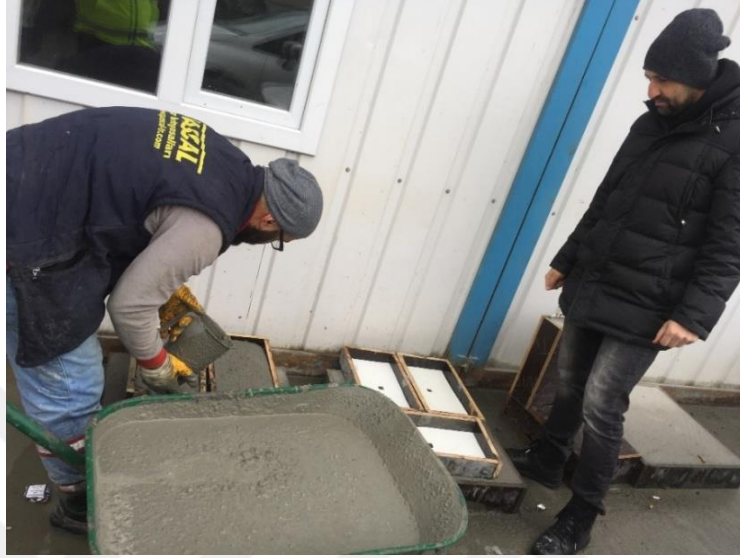
Resim 4.18 : Test Düzenegine Beton Dökülmesi.
