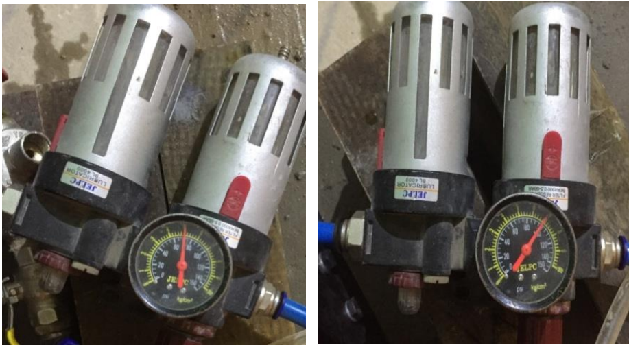
Resim 4.32 : Test Aşaması (5 bar 10 dakika) ve (7 bar 60 dakika).
