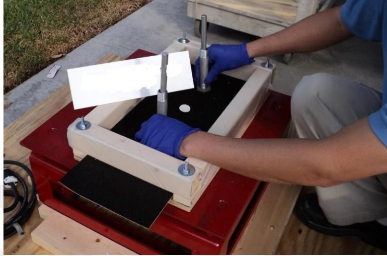
Resim 4.5 : Test Düzeneğine Taşma Tüpü Konulması.
