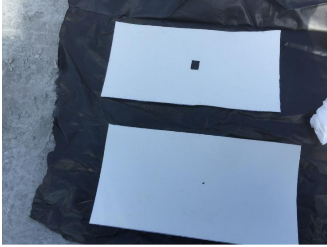
Resim 4.16 : Numune Malzemede Yırtık Açılması.
