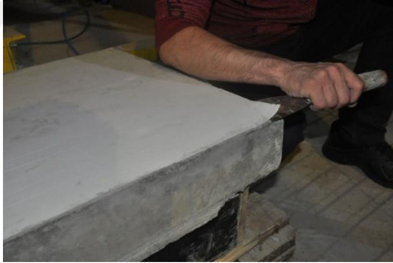
Resim 4.37 : Sıyrılma Testi Numunesinin Hazırlanması-1.
