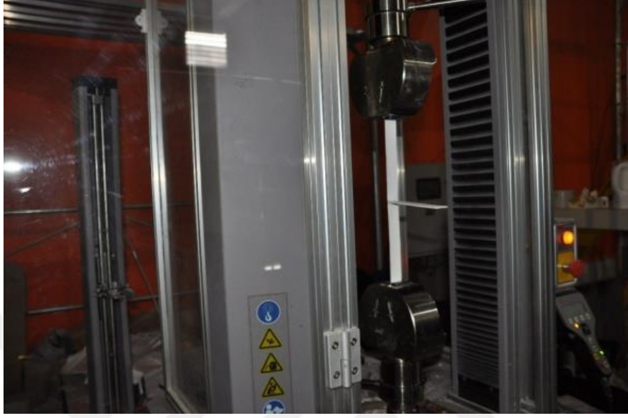
Resim 4.52 : Yapışma Test Aşaması-2.
