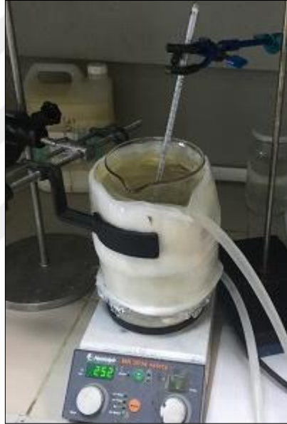
Şekil 7.1: Soğutma sirkülöründen ve buna bağlı yalıtımı yapılmış boruların sarılması ile hazırlanmış ceketten oluşan soğutma sistemi içerisinde grafen oksit reaksiyonu.
