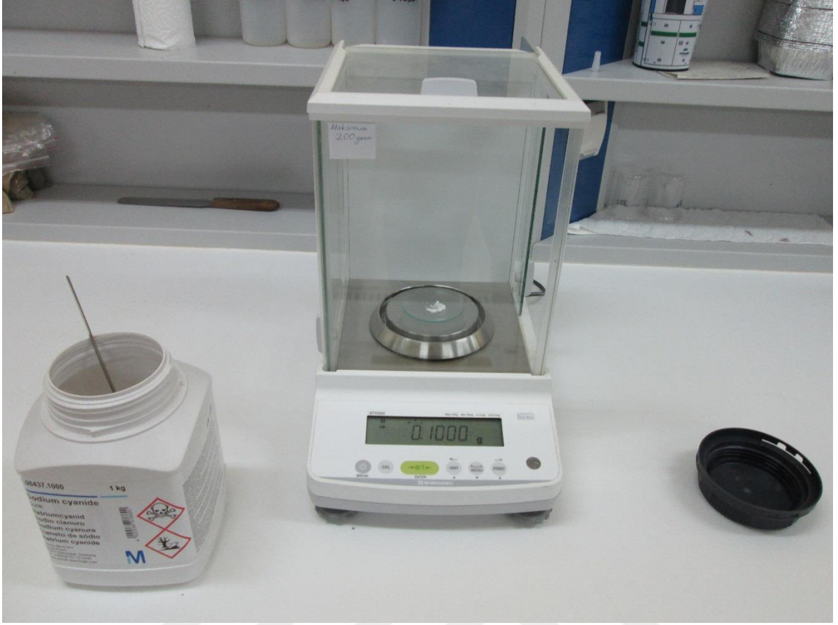
Şekil 3.2 Hassas tartı ile gerekli sodyum siyanür miktarının tartımı
