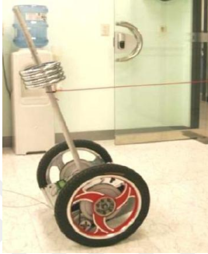
Şekil 2.4 İki tekerlekli ters sarkaç [15].
