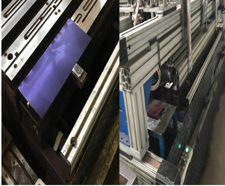
Şekil 3.6. Numunelerin cihaza yerleştirilmesi ve kaynak işlemine ait görseller.
