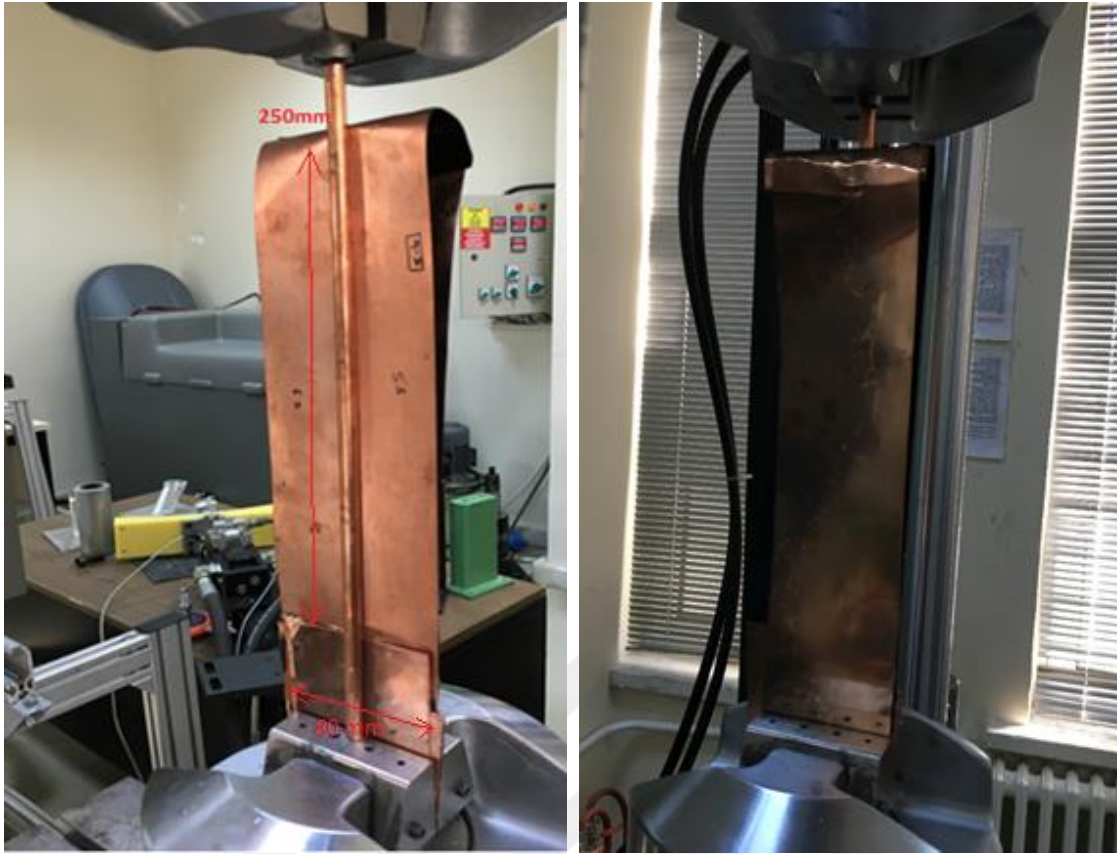
Şekil 3.11. Numunenin çekme test cihazına bağlanması ve gerilmeye bağlı kalan kaynak bölgesinin ölçüleri.
