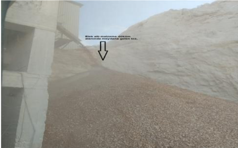
Şekil 1.6. Elekt altı (atık) malzemenin döküm alanında oluşturduğu toz konsantrasyonu
