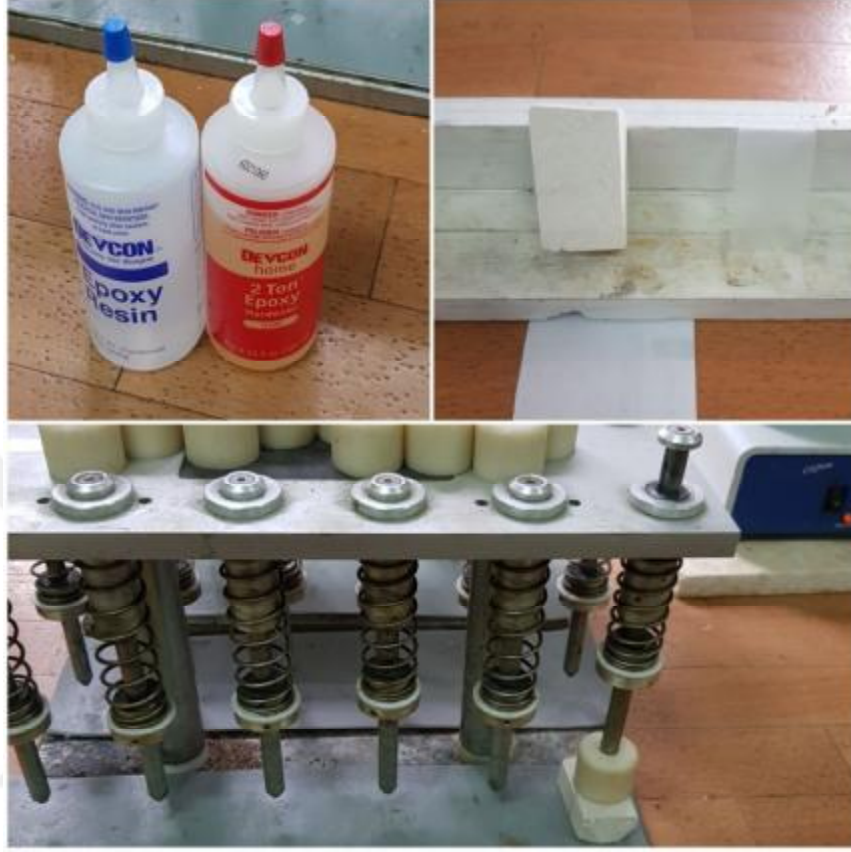
Şekil 3.7. İnce kesit hazırlanırken kullanılan yapıştırıcı, hızlandırıcı ve basınç cihazı
