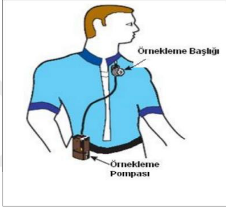
Şekil 3.5. Örnekleme Pompası ve Örnekleme Başlığı (Yılmaz, 2015)
