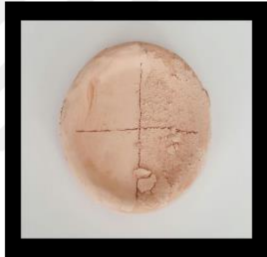
Görsel-32: Elenmemiş ve Elenmiş Atığın Plaka Üzerindeki Pişme Sonucu (1000°C)
