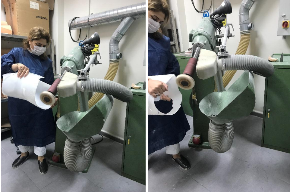
Şekil 5.3: Freze Makinesi İle Törpüleme İşlemi
