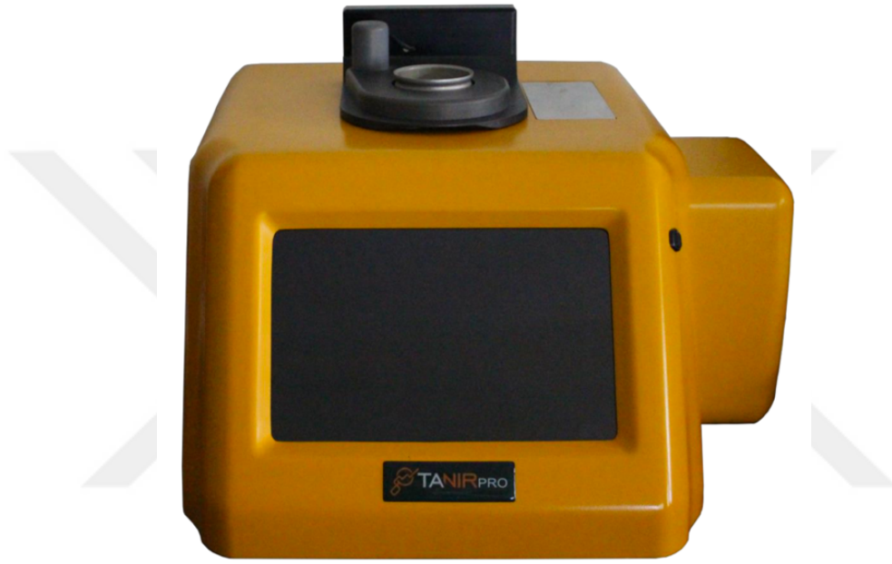
Şekil 4.19. Geliştirilen NIR reflektans spektrometresi
