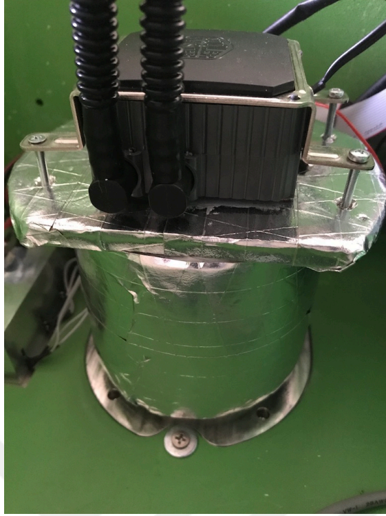
Şekil 4.7. Sıvı soğutma sistemi ve peltier yerleştirilmiş sıcaklık kontrol ünitesinin montajı yapılmış hali
