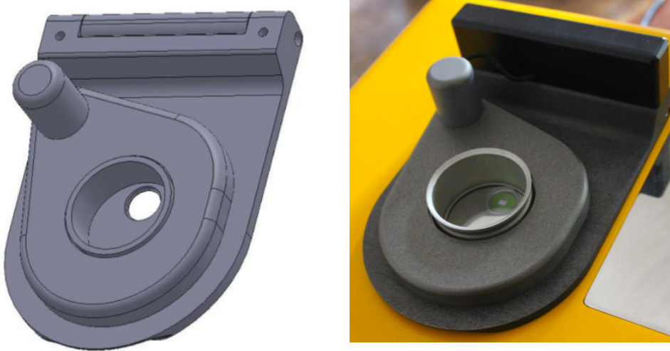
Şekil 4.3 Reflektans spektrometresinin sensör ile örnek haznesinin 3B çizimi ve alüminyum çıktısının montaj yapılmış hali
