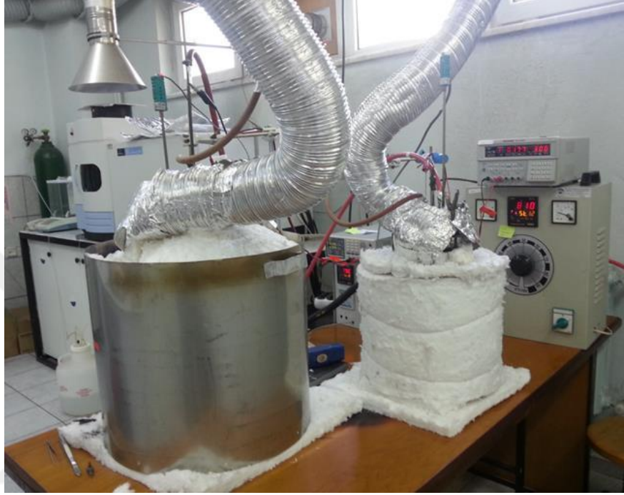
Şekil 6.1 Elektro-deoksidasyon işlemlerinin gerçekleştirildiği deney düzenekleri ve ilgili bağlantılar.
