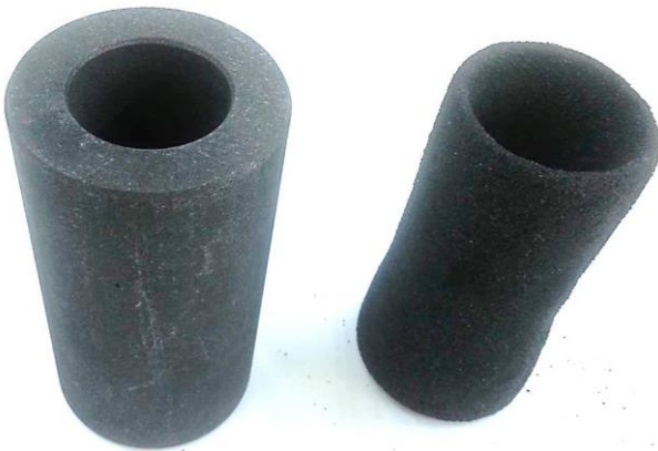
Şekil 7.9 Elektro-deoksidasyon deneylerinde kullanılan grafit potanın a) deney öncesi b) deney sonrası görüntüsü (Aybar, 2017)
