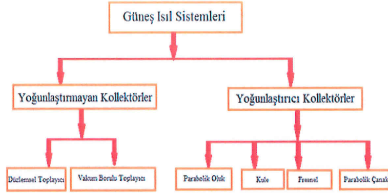
Şekil 1.2. Güneş ısı sistemlerinin sınıflandırılması.
