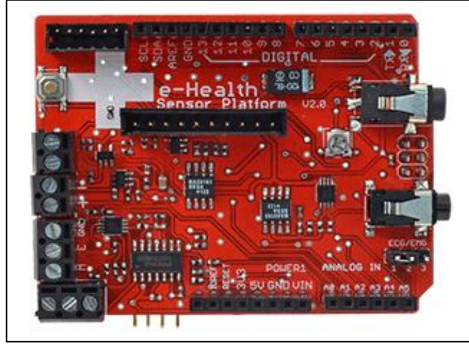
Şekil 2.6. e-Sağlık algılayıcı kalkanı bağlantıları [18]
