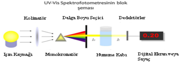
Şekil 2.2. Bir spektrofotometre cihazı diyagramı
