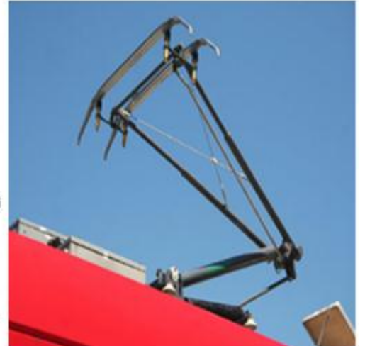
Şekil 3. 40. Tipik bir pantografin parçaları ve trenin çatısına yerleştirilmiş pantograf (Özmen İ., 2014)
