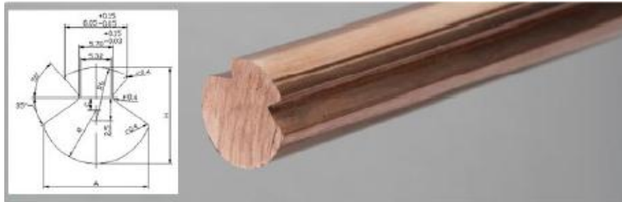
Şekil 3. 16. Seyir teli ve kesiti (NeTIRail, 2015)
