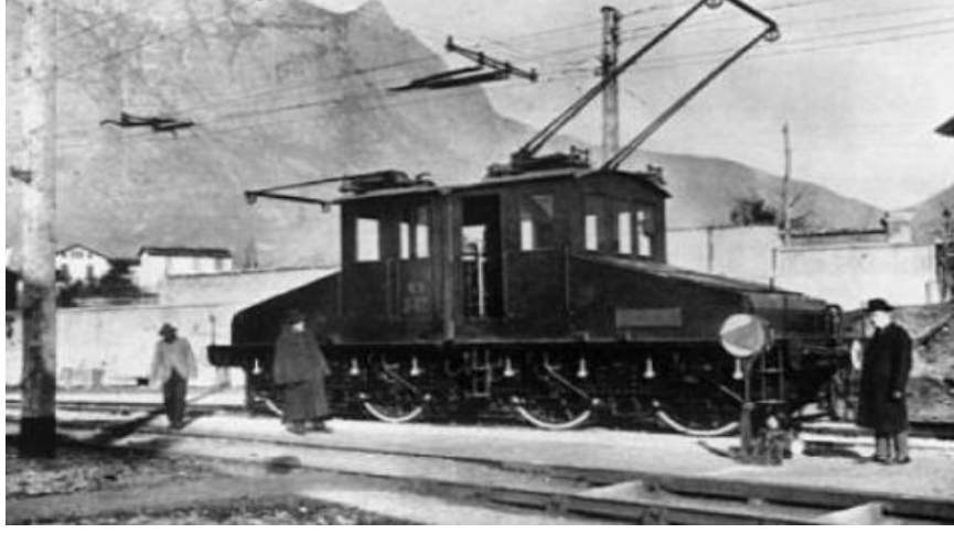
Şekil 3. 47. (1898-1902) Valtellina hattında AC lokomotif (Frey,2012)
