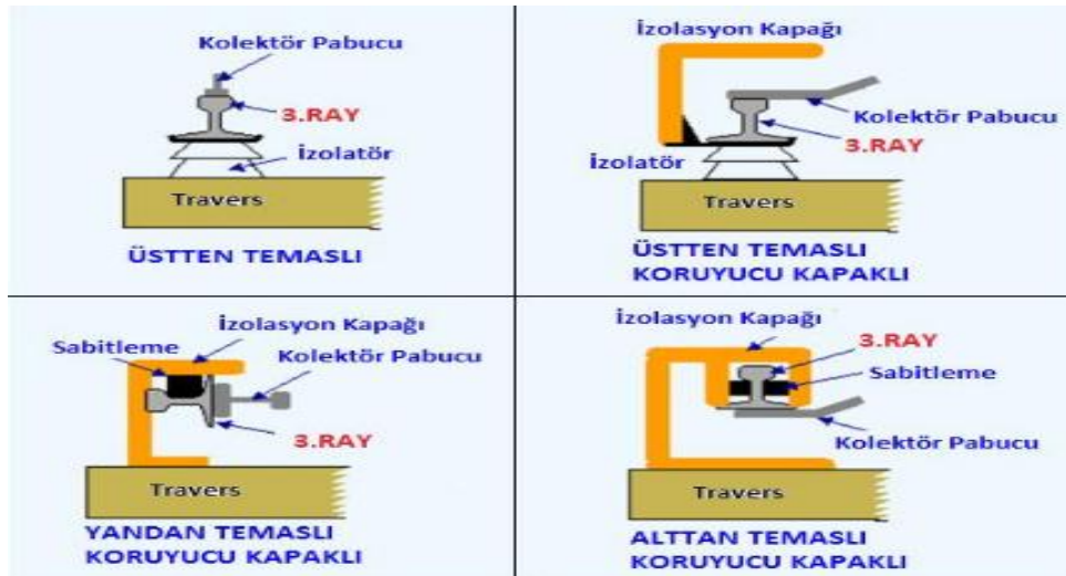
Şekil 3. 42. Üçüncü ray sisteminin tipleri (Özmen İ., 2014)
