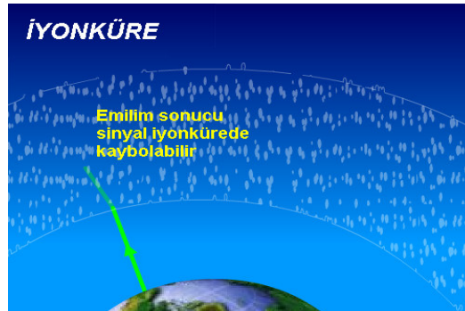
Şekil 3.11, Gök dalgaları iyonküre şartları ve hava buharı gibi atmosferik şartlar dolayısıyla enerji kaybedip atmosferde kaybolabilir.
