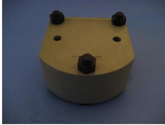
Resim 2.5. Mikrodalga enerjisi ile polimerizasyon yönteminde kullanılan fiberle güçlendirilmiş plastik mufla.
