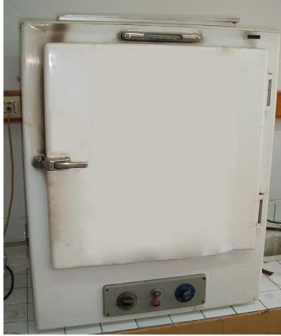
Resim 2.4. Isı ile polimerizasyon yönteminde kullanılan termostatlı fırın.
