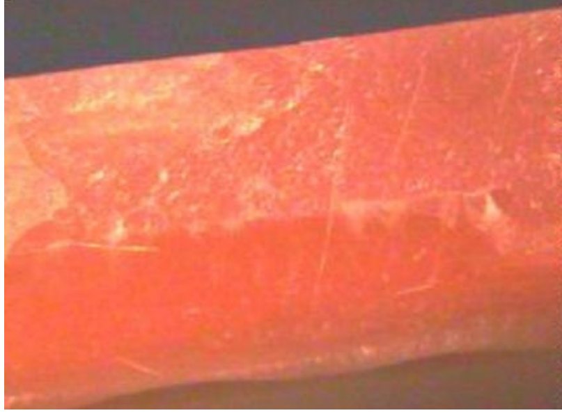
Resim 3.15. Çarpma dayanıklılığı testi sonrası mikrodalga ile polimerize Stick Net cam fiberli test örneğine ait kırık yüzeyi.
