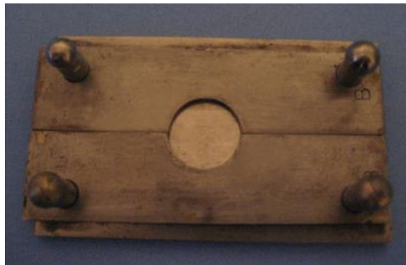
Resim 2.14. Artık monomer test örneklerinin hazırlanmasında kullanılan metal kalıp.
