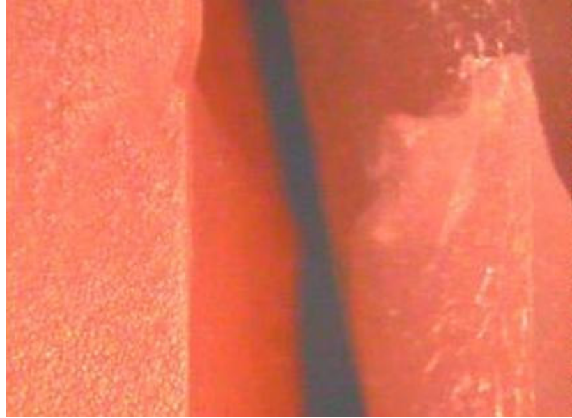
Resim 3.1. Transvers dayanıklılık testi sonrası ısı ile polimerize kontrol grubu test örneğine ait kırık yüzeyi.
