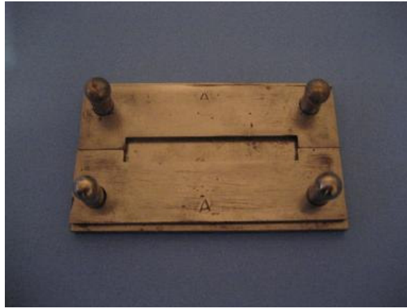
Resim 2.8. Transvers dayanıklılık örneklerinin hazırlanmasında kullanılan metal kalıp.
