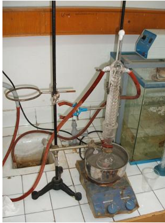
Resim 2.15. Artık monomer ekstraksiyon (seçici ayırma) düzeneği.
