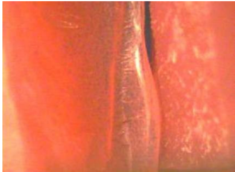
Resim 3.5. Transvers dayanıklılık testi sonrası mikrodalga ile polimerize kontrol grubu test örneğine ait kırık yüzeyi.
