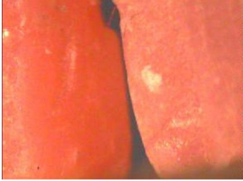
Resim 3.11. Çarpma dayanıklılığı testi sonrası ısı ile polimerize Stick Net cam fiberli test örneğine ait kırık yüzeyi.
