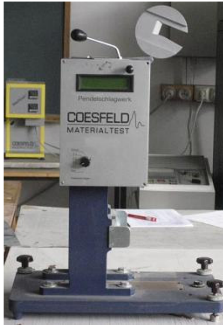
Resim 2.12. Çarpma dayanıklılığı tesbitinde kullanılan Charpy tipi test cihazı.
