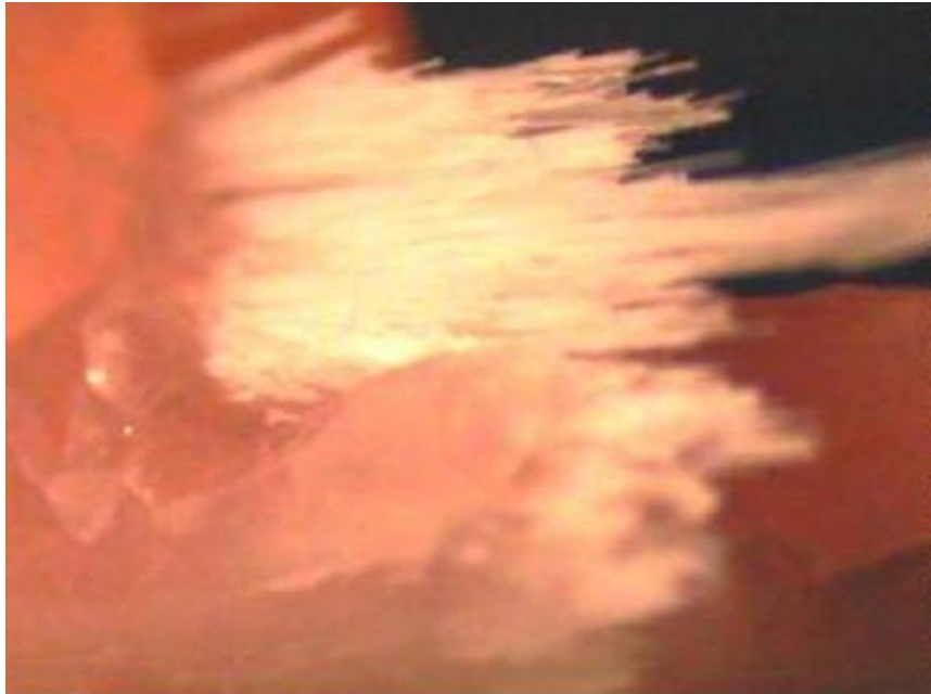
Resim 3.10. Çarpma dayanıklılığı testi sonrası ısı ile polimerize Stick cam fiberli test örneğine ait kırık yüzeyi.
