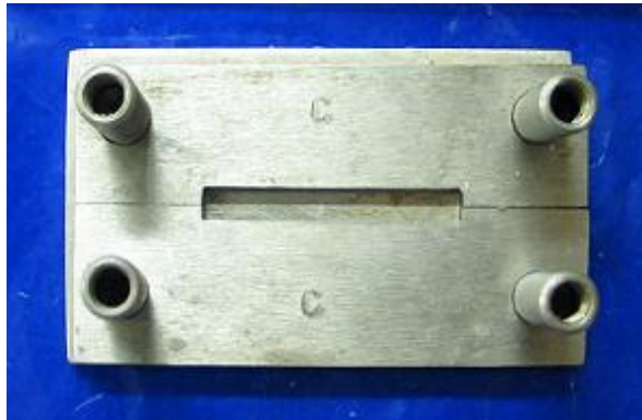
Resim 2.11. Çarpma dayanıklılığı örneklerinin hazırlanmasında kullanılan metal kalıp.
