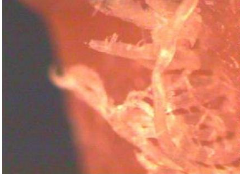
Resim 3.16. Çarpma dayanıklılığı testi sonrası mikrodalga ile polimerize Ribbond polietilen fiberli test örneğine ait kırık yüzeyi.
