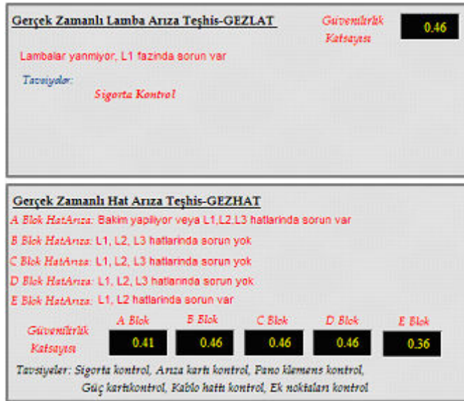
Şekil IV.31 GEZHAT’da A blok 3 Faz, E Blok 2 Faz Arıza ve GEZLAT Fonksiyonu ile Uyumluluk
