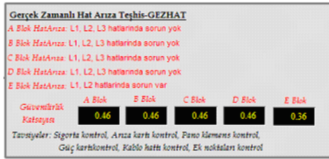
Şekil IV.29 E Blokta Hat Arızasında GEZHAT Fonksiyonu
