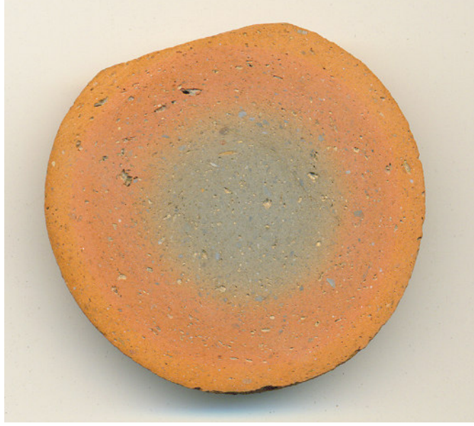
Şekil 3.3 Hisarönü amforasının dip bölümünden alınan parçanın görünümü çap yaklaşık 5 cm'ye karşılık gelmektedir. Merkezde yer alan 2 cm çaplık bölüm (black-core) indirgen ortamı temsil etmektedir.
