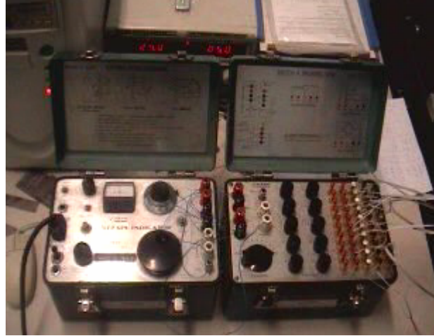
Şekil 4.131 Gerinim-ölçme cihazına bağlantı tellerinin bağlanması
