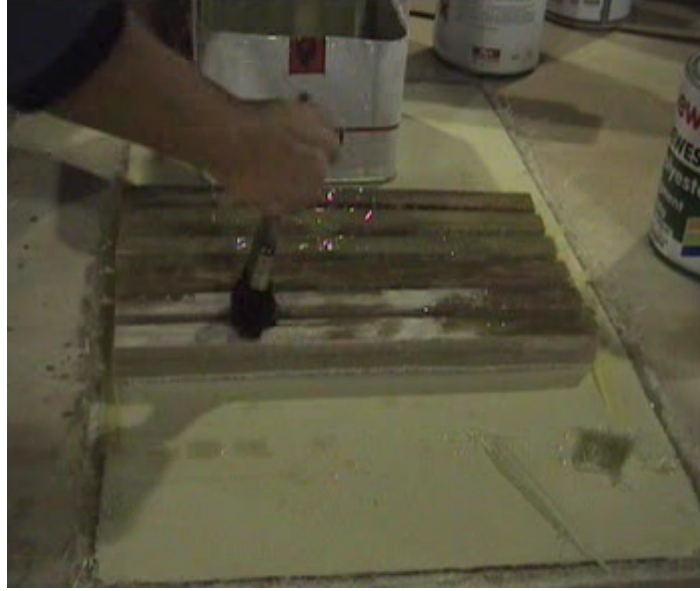
Şekil 4.5 Numune çekirdek yüzeylerine polyester emdirilmesi
