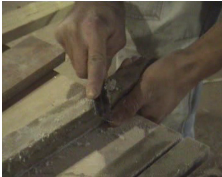
Şekil 4.6 Numune yüzeylerinin falçata yardımıyla artıklardan temizlenmesi
