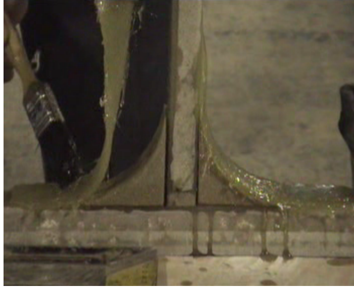
Şekil 4.15 Dönümlü 70 mm sandviç T bağlantısında üstkatmanlama
