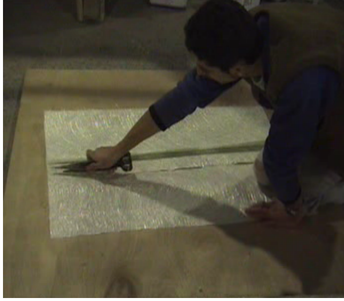
Şekil 4.2 Doğranmış cam elyafın uygun boyutlarda kesilmesi
