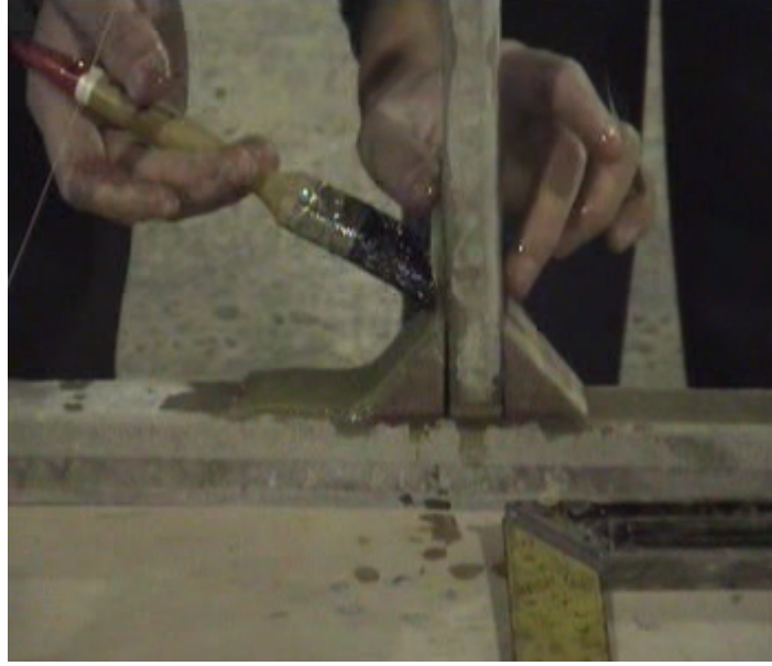
Şekil 4.13 Üçgen sandviç T bağlantısında üstkatmanlama
