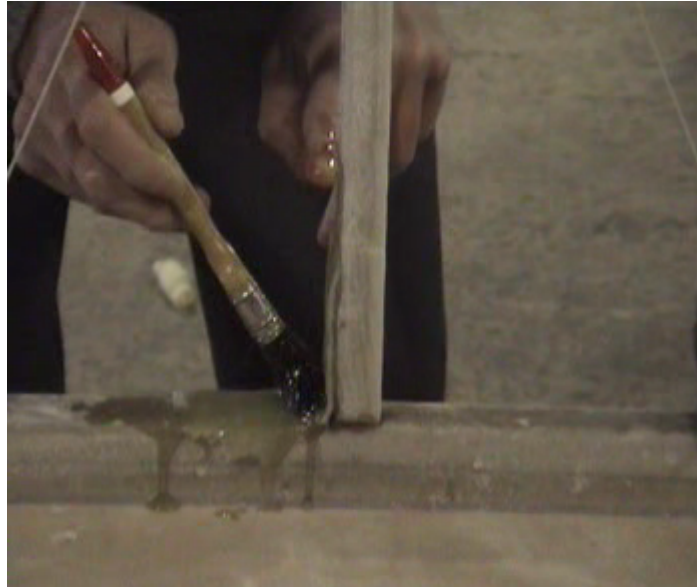
Şekil 4.8 Düz sandviç T bağlantısında üstkatmanlama
