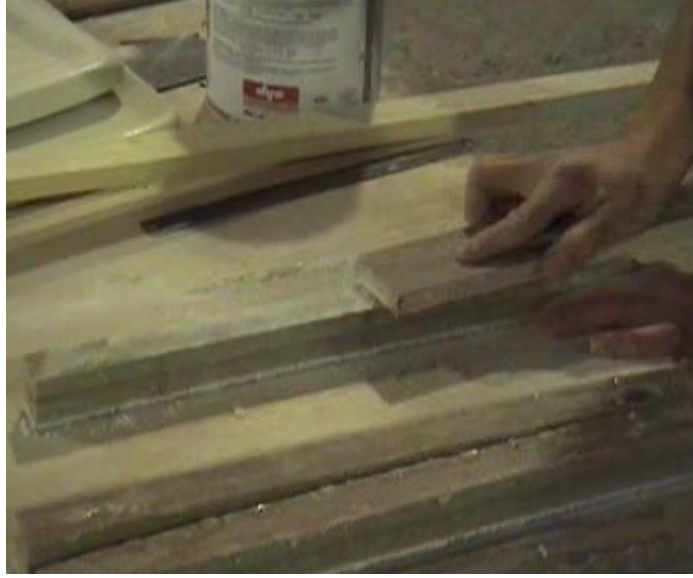
Şekil 4.7 Numune yüzeyinin düzgün hale getirilmesi
