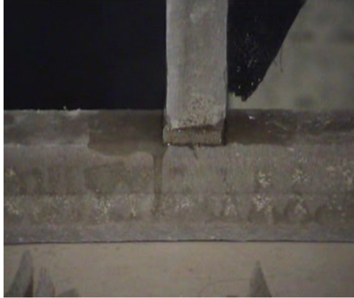
Şekil 4.12 Tekne gövdesi ile tekne bölmesi arasına çekirdek eleman konulması
