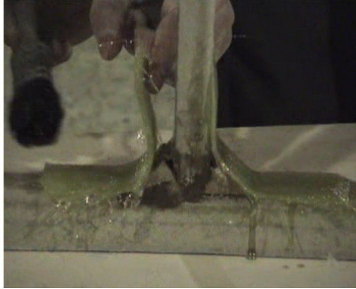
Şekil 4.16 Yeni tip sandviç T bağlantısında üstkatmanlama
