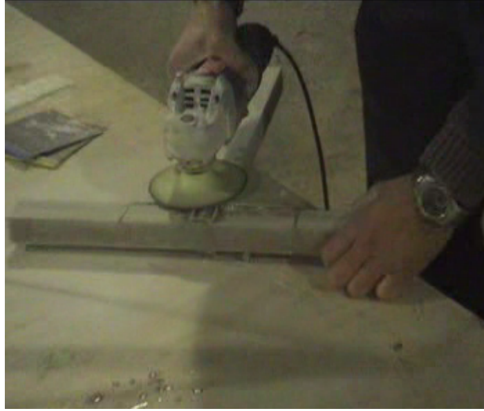
Şekil 4.9 İmal edilen numunenin son boyutlarına getirilmesi
