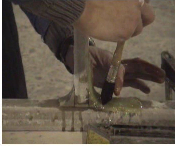
Şekil 4.14 Dönümlü 25mm sandviç T bağlantısında üstkatmanlama
