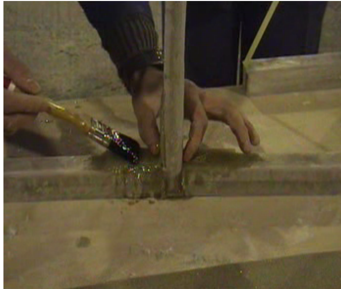
Şekil 4.11 İçiçe geçmeli sandviç T bağlantısında üstkatmanlama
