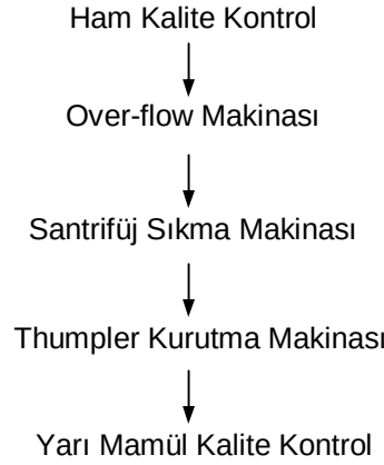
Şekil 6.2. Ön terbiye işlemi proses akış şeması
