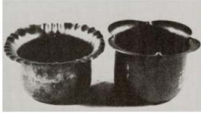
Şekil 5.4 Silindirik çekme ile elde edilen farklı özellikteki malzemelerden imal edilen kaplarda, yetersiz baskı plakası kuvveti sonucu kulak oluşumu.
