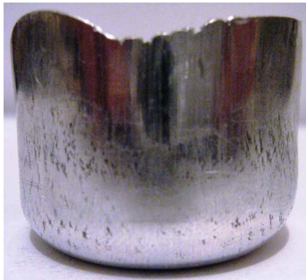
Şekil 7.10 15°'lik kalıpta elde edilebilen optimum iş parçası
