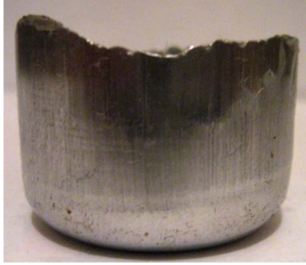
Şekil 7.9 12,5°'lik kalıpta elde edilebilen optimum iş parçası.
