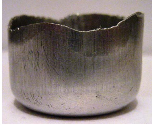
Şekil 7.7 7,5^\circ 'lik kalıpta elde edilebilen optimum iş parçası.
