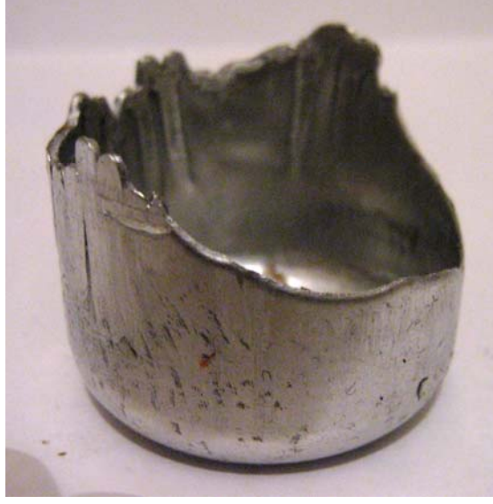
Şekil 7.3 Baskı plakası kuvvetinin fazla olduđu durumlarda meydana gelen kopma ve kırılmalar
