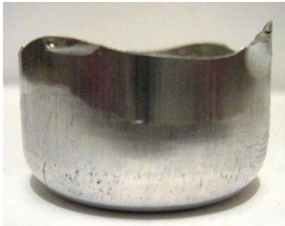
Şekil 7.6 5°'lik kalıpta elde edilebilen optimum iş parçası.
