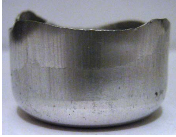
Şekil 7.5 2,5°'lik kalıpta elde edilebilen optimum iş parçası.
