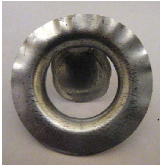
Şekil 7.2 Çekme oranının büyük olmasından dolayı parçada meydana gelen yırtılma.
