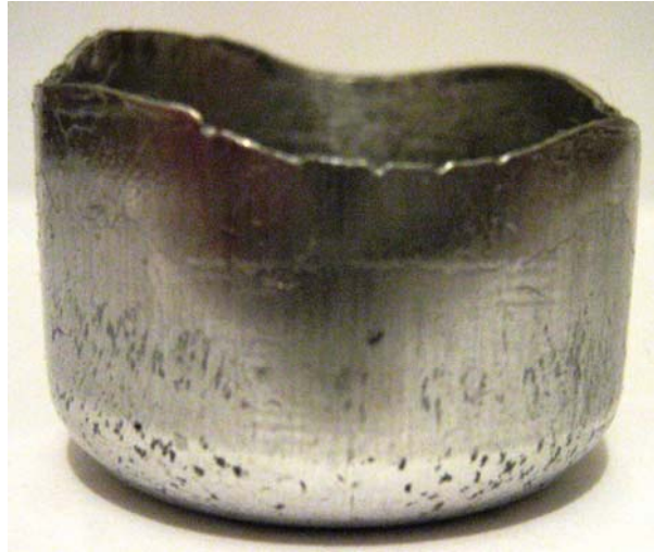
Şekil 7.8 10^\circ 'lik kalıpta elde edilebilen optimum iş parçası.
