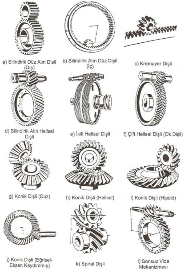
Şekil 3.6. Dişli çark mekanizmaları [Babalık, 2006]
