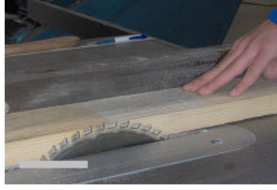
Resim 7.51 Daire testerede boy kesme işlemi
