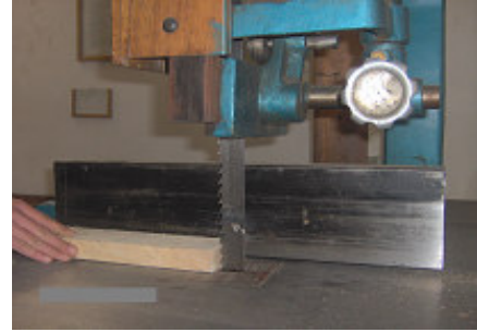
Resim 7.29 Şerit testerede parça kesimi
