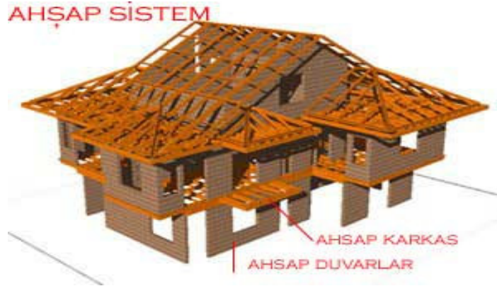
Resim 5.5 Kagirahşabın ahşap sistemi
