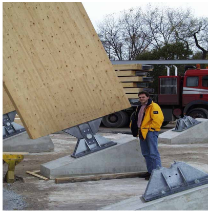
Resim 5.4. Lamine ahşap panel
