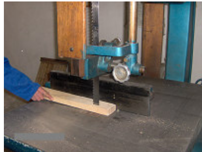
Resim 7.30 Şerit testerede doğru kesim
