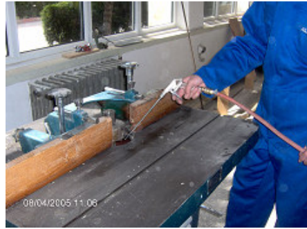
Resim 7. 64 Makinenin basınçlı hava ile temizliği
