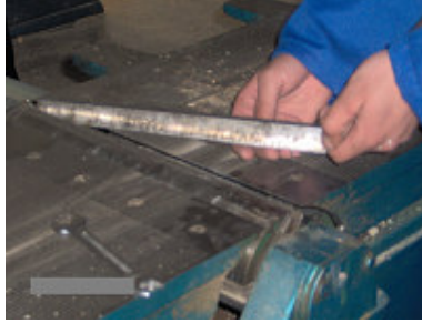
Resim 7.41 Bıçakların sökölüp değıştirilmesi
