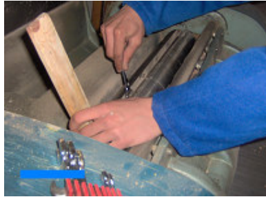
Resim 7.47 Kalınlık makinesinin bıçak değişimi
