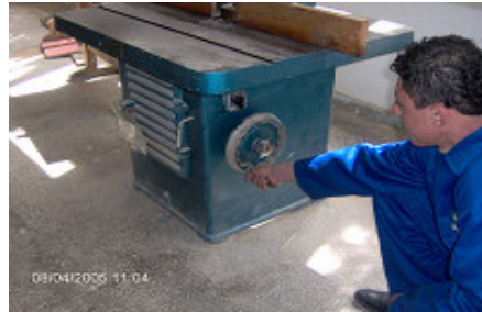
Resim 7.59 Bıçak yüksekliğinin ayarlanması
