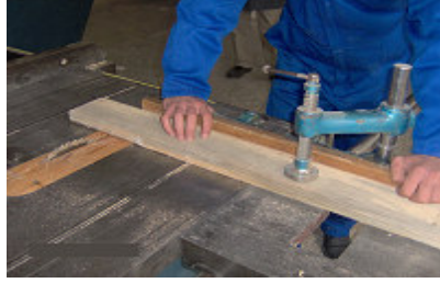
Resim 7.52 Daire testerede baş kesme işlemi
