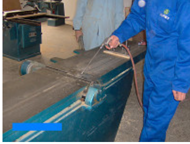
Resim 7.43 Basınçlı hava ile temizlenmesi
