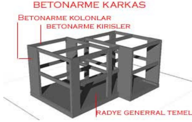
Resim 5.6 Kagirahşabın betonarme karkas sistemi
