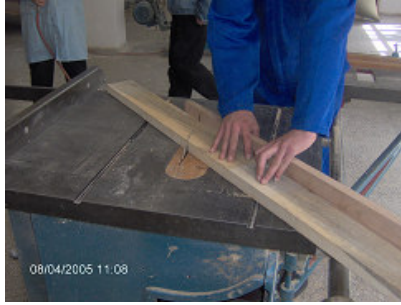
Resim 7.53 Daire testerede açılı kesme
