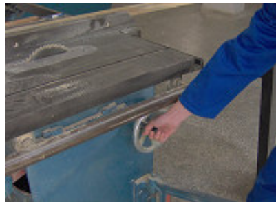
Resim 7.50 Bıçak eğiminin ayarlanması.
