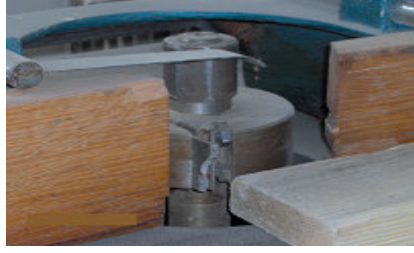
Resim 7.60 Mil dönüşünün kontrolü
