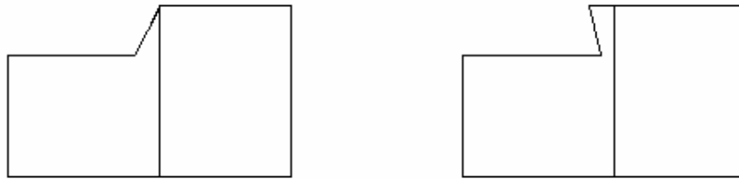
Şekil 8.17 Hampaylı zıvanalı köşe birleştirme işi markalama işlemi ve hampay çeşitleri
