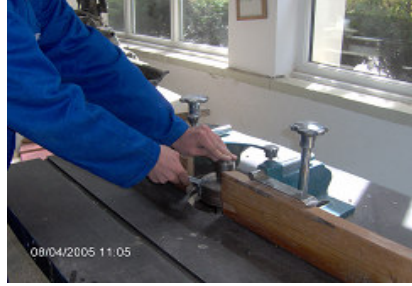
Resim 7.63 Freze topuna uygun bıçağın takılması
