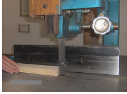
Resim 7.28 Testere kılavuz siperinin ayarlanması
