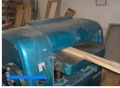
Resim 7.46 Ahşap parçanın kalınlıktan geçirilmesi
