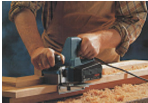
Resim 7.26 El Planya Makinesi (MEB 2005)
