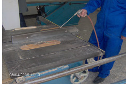
Resim 7.57 Makinenin basınçlı hava ile temizlenmesi.
