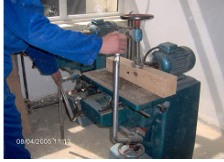
Resim 7.66 Yatay Delik Delme Makinesinin Kullanımı
