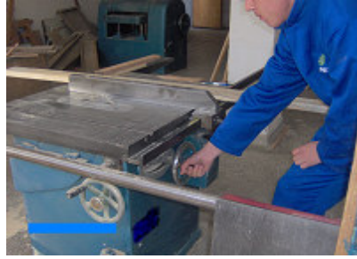
Resim 7.49 Bıçak yüksekliğinin ayarlanması
