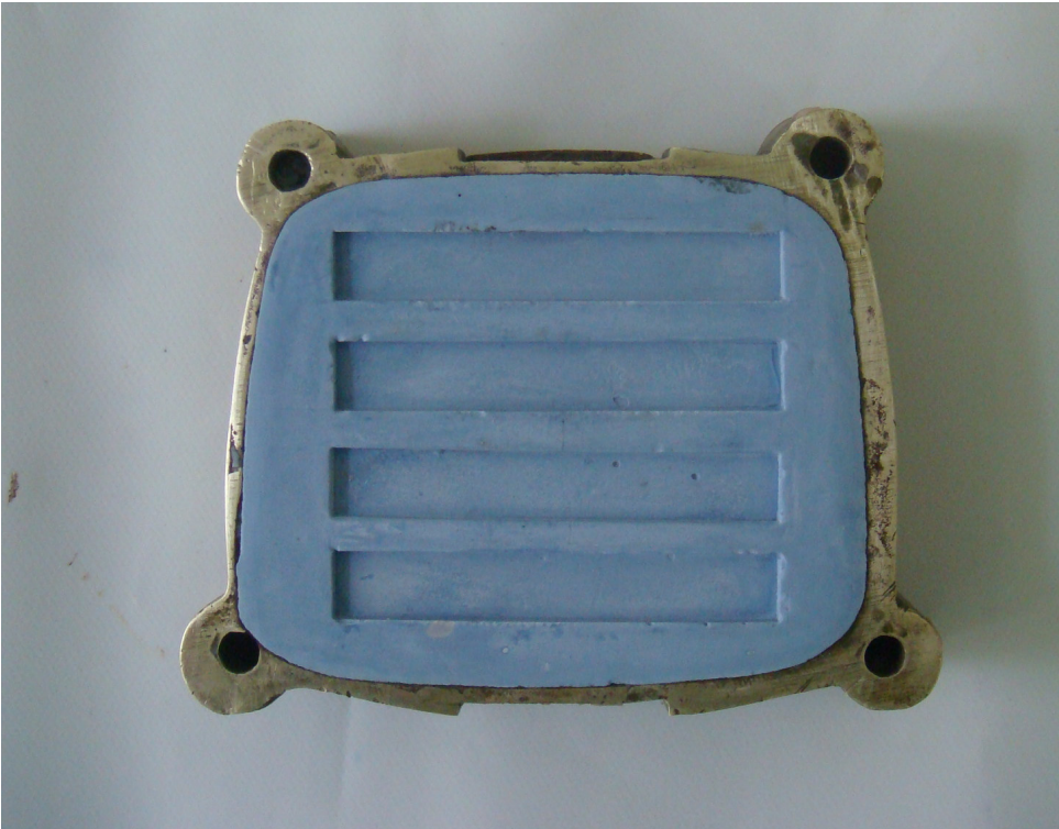
Şekil 3-6: Paslanmaz çelikten yapılan yer tutucuların çıkarıldıktan sonraki muflanın görünümü
