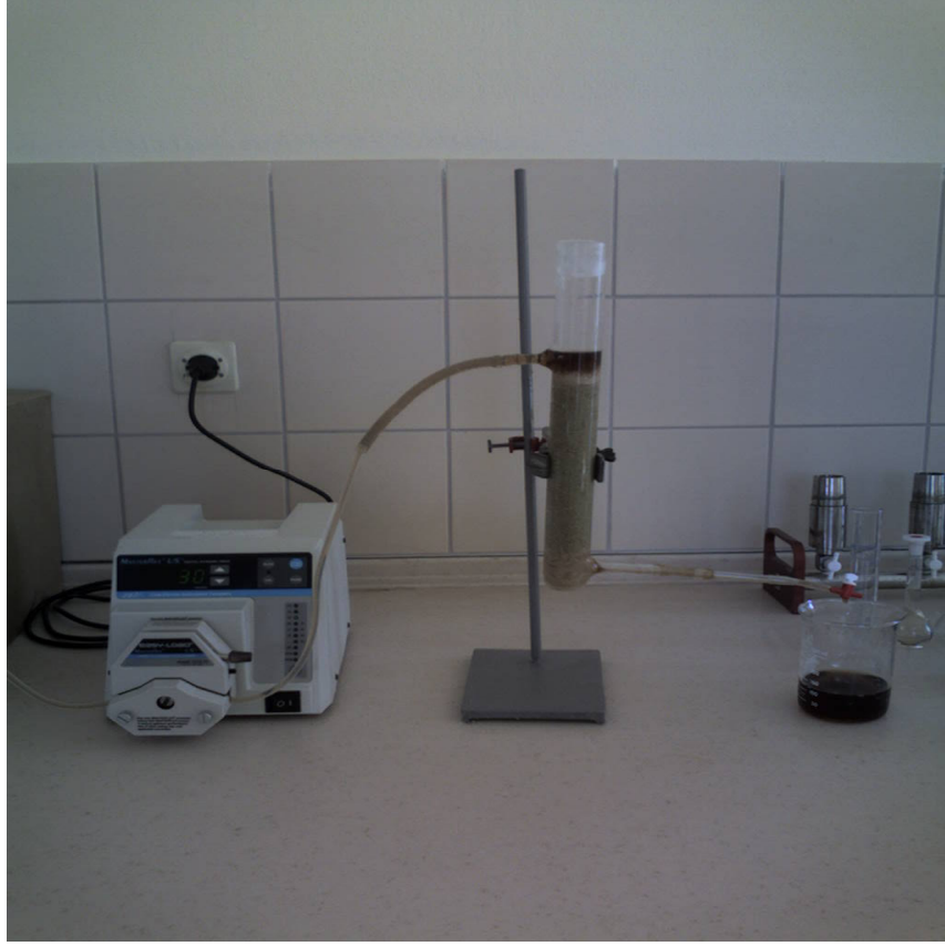
Şekil 3.5. Sızıntı Suyu Arıtımında Sürekli Sistem Deney Düzeneği
