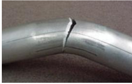
Şekil 1.18. Boru bükme operasyonlarında dış çapta meydana gelen yırtılma [Granelli, 2006].
