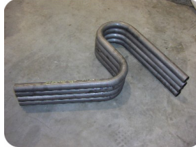
Şekil 1.12. Dönüştürücü çekerek boru bükme yöntemi ile bükülen boru parçaları.
