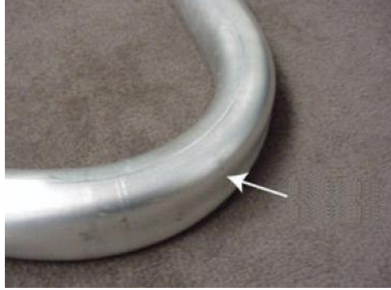
Şekil 1.16. Boru bükme operasyonunda yassılaşıma kusuru [Granelli, 2006].
