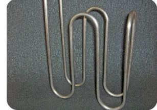
Şekil 1.12. Dönüştürücü çekerek boru bükme yöntemi ile bükülen boru parçaları.
