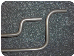
Şekil 1.12. Dönüştürücü çekerek boru bükme yöntemi ile bükülen boru parçaları.
