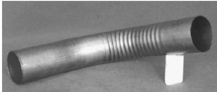
Şekil 1.19. Boru bükme operasyonlarında iç çapta meydana gelen burkulma [Yang, 2004].
