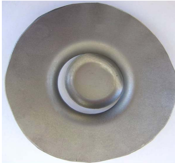
Şekil 6.10 Çekme oranının büyük olmasından dolayı parçada meydana gelen yırtılma.
