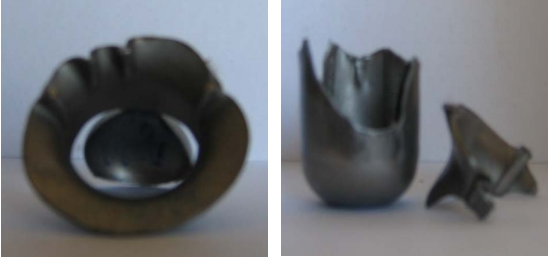
Şekil 6.11 Baskı plakası kuvvetinin fazla olduğu durumlarda meydana gelen kopma ve kırılmalar.
