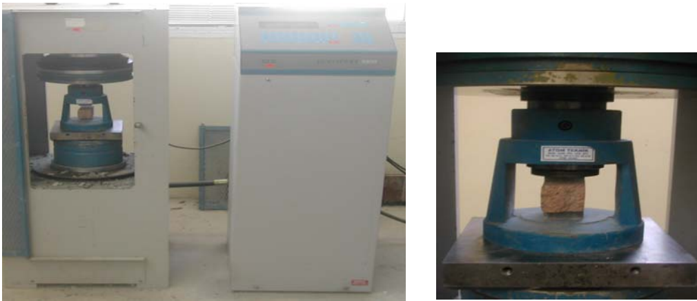
Şekil 6.6 Basınç deneyi presi
