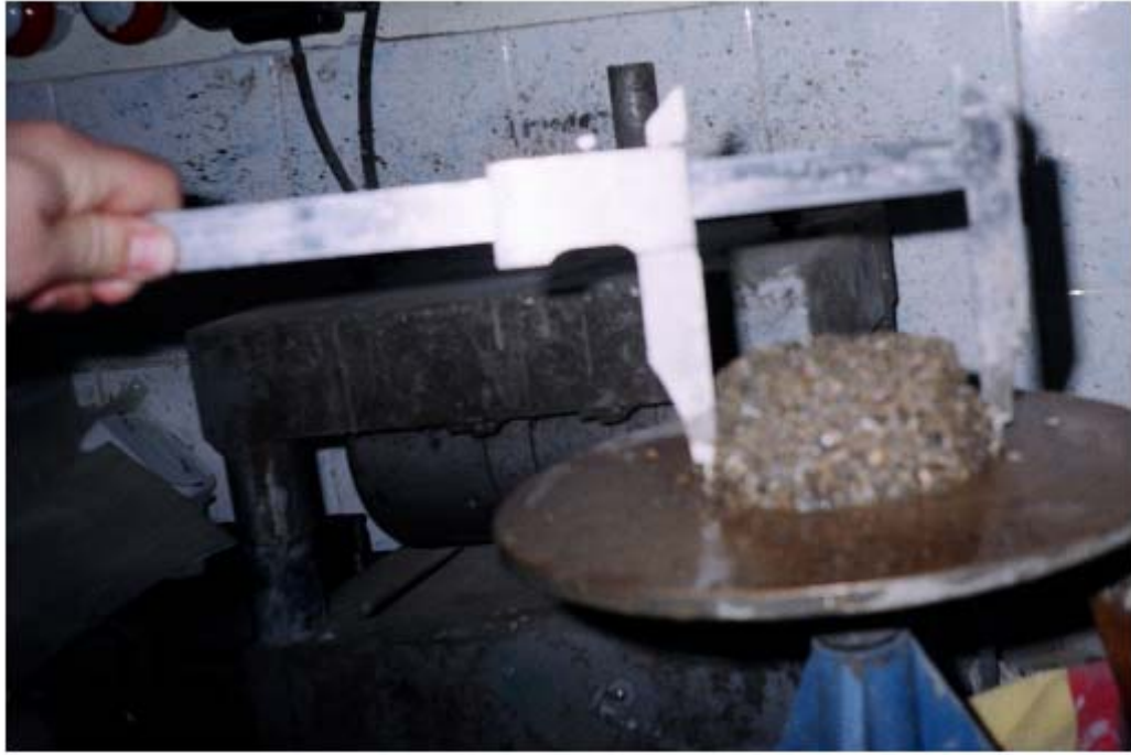
Şekil 6.3 Kumpas yardımıyla çimento harcında yayılma değerinin ölçülmesi.
