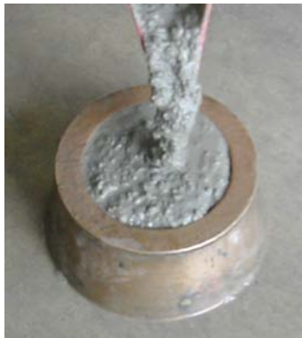
Şekil 6.4 Mini çökme hunisinin doldurulması ve yayılmanın ölçülmesi
