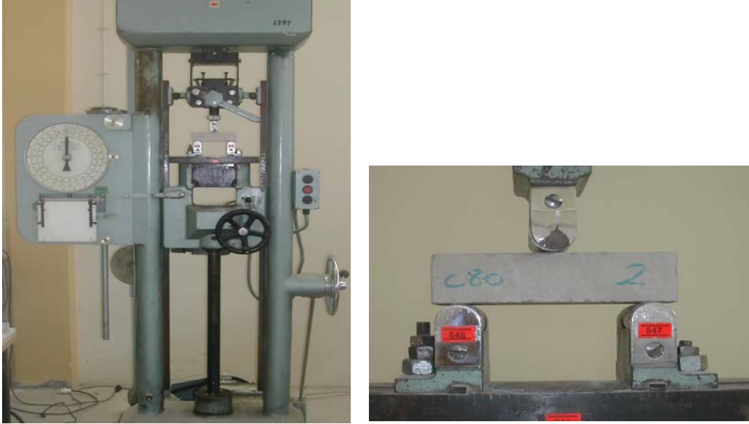
Şekil 6.5 Eğilme deneyi presi
