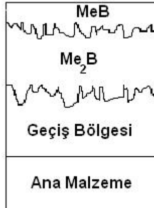
Şekil 2.3. Borlama sonrasında alaşımsız çelikte MeB ve Me 2 B fazlarının şematik gösterimi (Me: Fe, B: Bor) [48].
