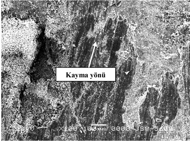
Resim 5.30. Tane boyutu 8,61 μm olan %10 Al 2 O 3 içeren MMK'nın aşınmış yüzeyi
