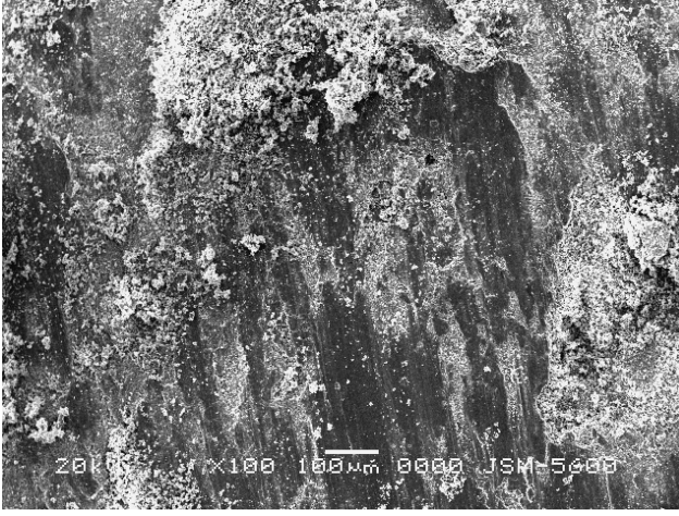
Resim 5.34. 3,5 MA yapılmış tane boyutu 3,01 \mu\text{m} olan %15 \text{Al}_2\text{O}_3 içeren MMK'nın aşınmış yüzeyi
