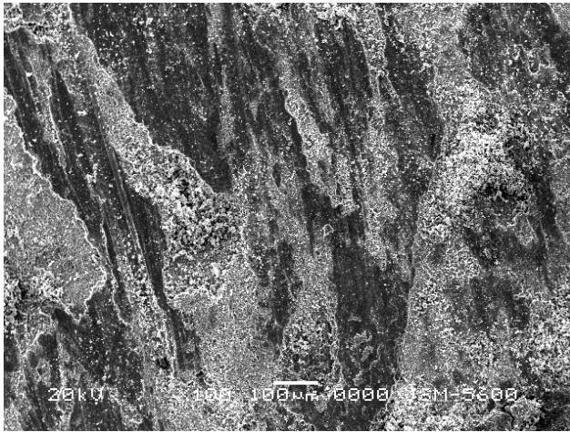
Resim 5.26. Tane boyutu 15,99 \mu\text{m} olan % 5 \text{Al}_2\text{O}_3 içeren MMK'nın aşınmış yüzeyi
