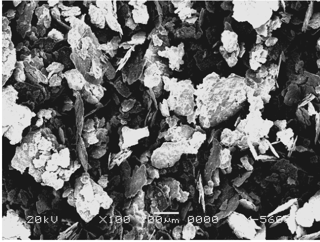
Resim 5.5. 3,5 saat MA yapılmış 102,35 µm tane boyutlu 2014 Al alaşım tozu
