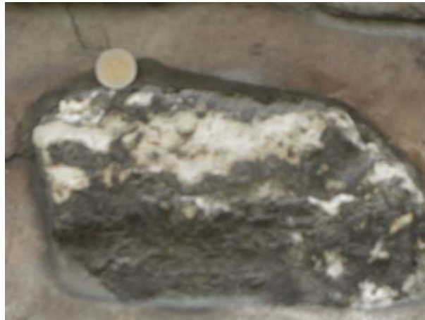
Şekil 5.15. Köprülü Medrese İçi Kapı Girişi Sağ Duvarında Oluşan Jips Tabakasına ait Örnek (S2 Kodlu Numune)
