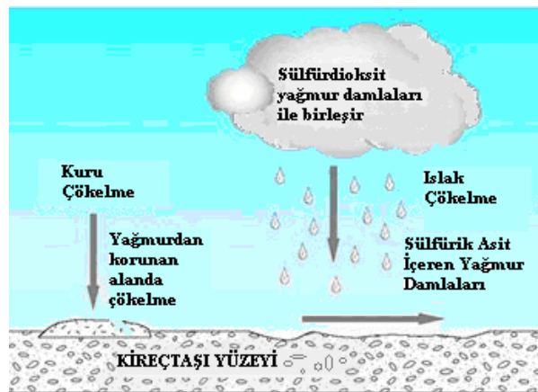
Şekil 2.4. SO_2 'nin kireçtaşı yüzeyinde kuru ve yaş depolanması
