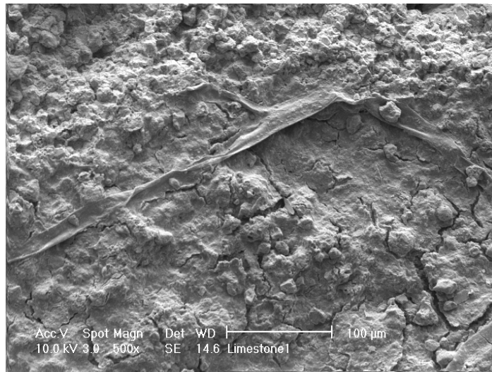
Şekil 5.19. S16 Kodlu Kütüphane Doğu Cephesine Ait Örneğin SEM Analizi, (altere yüzey, jips)
