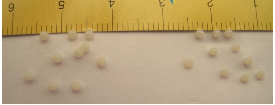
Şekil 6.10 Kitosan boncukları. Soldan sağa % 0,3 Aljinat ve % 0,5 Aljinat kullanılarak hazırlanan kitosan boncukları görülmektedir.
