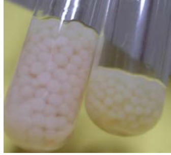
Şekil 6.9 TPP (%2) ve NaOH:Metanol:dH 2 O (1:10:10 v/v/v) kullanılarak hazırlanan kitosan boncukları. Solda NaOH-MeOH ile hazırlanan sağda ise TPP ile hazırlanan kitosan boncukları görölmektedir.
