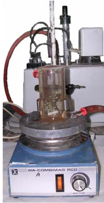
Şekil 5.3 Kesikli karıştırılmalı tank reaktör sistemi.
