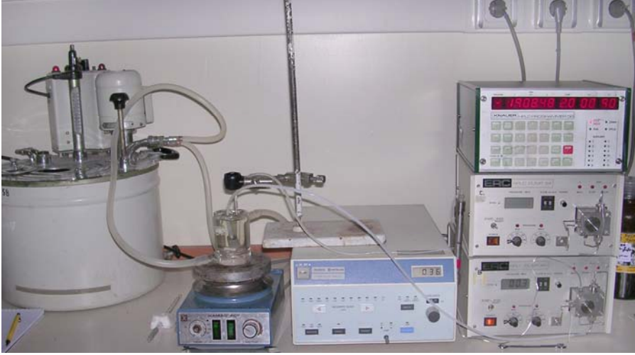
Şekil 5.2 Sürekli akış kolon reaktör sistemi.
