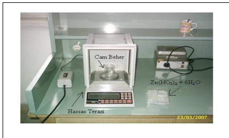
Şekil 3.3. Hassas terazi ile 0,1 M \text{Zn}(\text{NO}_3)_2 + 6\text{H}_2\text{O} kütle ölçümü.
