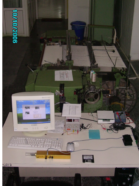
Şekil 3.1 Deney düzeneğinin kullanılan dokuma makinesinin görünümü
