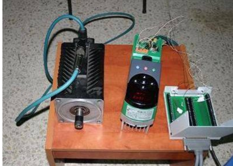
Şekil 3.10 Servo motor ve sürücüsü
