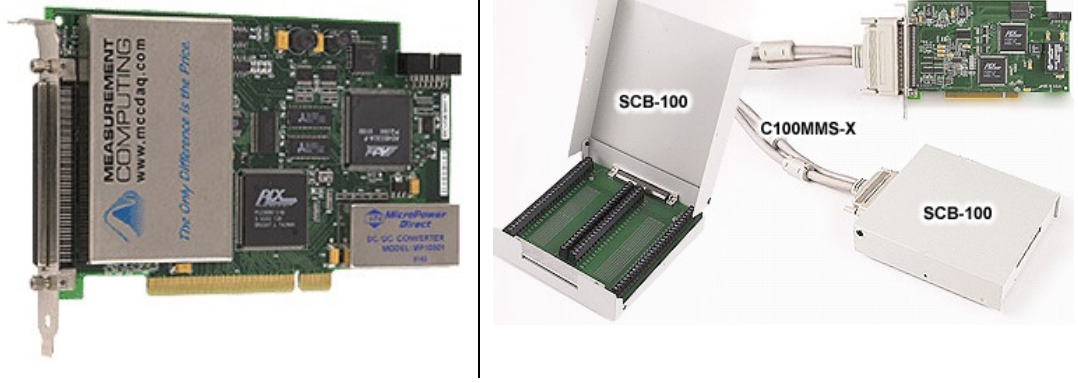
Şekil 3.14 Veri toplama kartı ve bağlantı aparatı (PCI-DAS6071)
