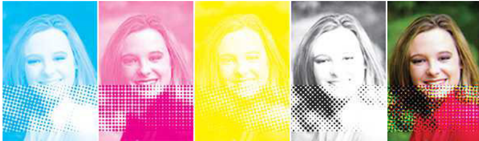
Şekil II. 7 Basılacak Orijinalin Renk Ayrımı ve Renk Ayrımı Sonucu Baskı [25]
