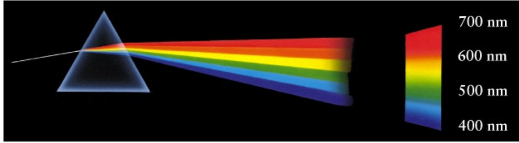
Şekil II. 21 Beyaz Işığın Kendini Oluşturan Renklere Ayrılması
