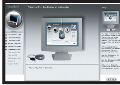
Şekil II. 43 Spektrofotometrenin Ekrana Monte Edilmesi
