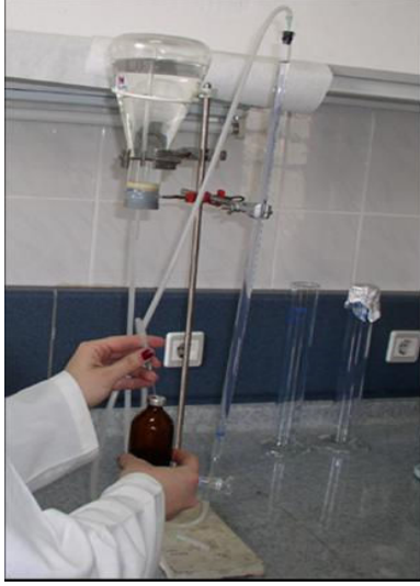
Şekil 15. BMP testlerinde gaz ölçümünde kullanılan deney düzeneği.
