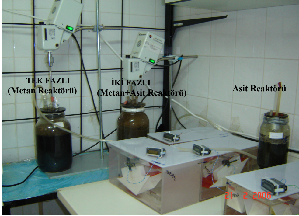
Şekil 17. Tek ve İki Fazlı Reaktör Düzenekleri
