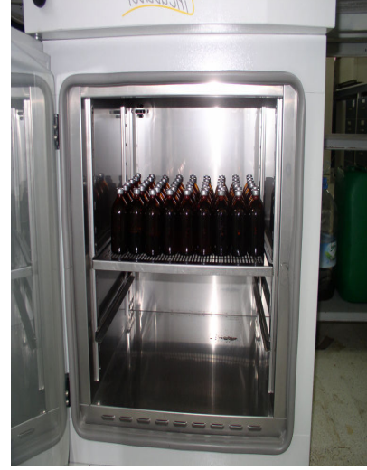
Şekil 16. Biyoreaktörlerin yer aldığı otomatik çalkalamalı inkübatör
