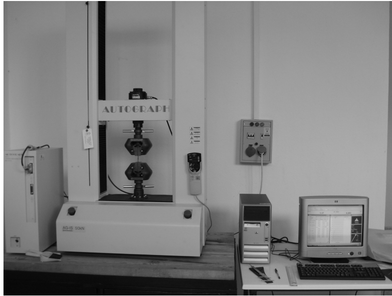
řekil 4.3 Kesme-makaslamanın yapıldığı test cihazı.
