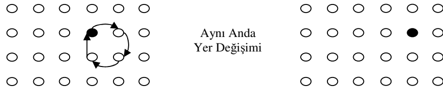
Şekil 2.7 Halka mekanizmasında atomların yer değiştirmesi (● Arayer atomu , ○ komşu kafes atomlar ) (Demirci, 2004).
