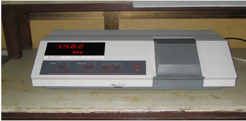
Şekil III.8. Spektrometre, 0,5 cm veya Daha Uzun Işık Yollu Küvetli
