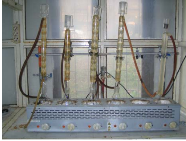
Şekil III. 7. Geri Soğutucuda Yapılan KOİ Deneyi
