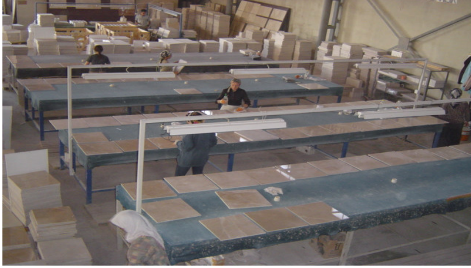
Şekil 2.5.2.8-1 Bitiş ünitesi tamirat masaları
