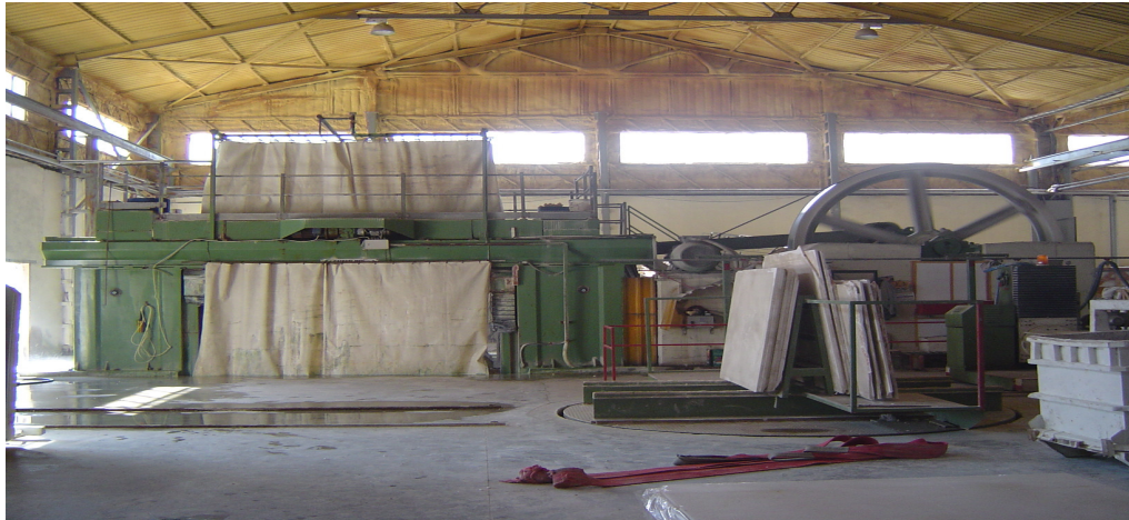
Şekil 2.5.1.1-1 Gaspari Menotti marka katrak
