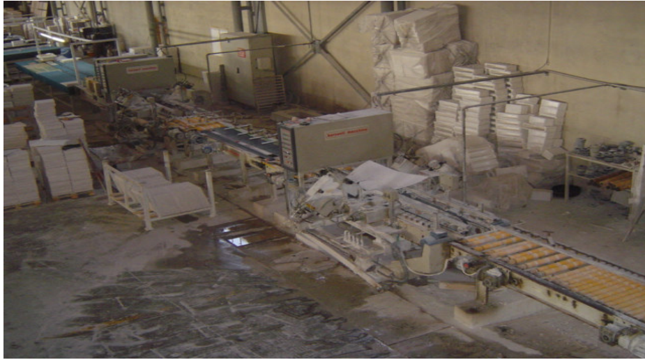
Şekil 2.5.2.7-1 Pah kırma makine grubu
