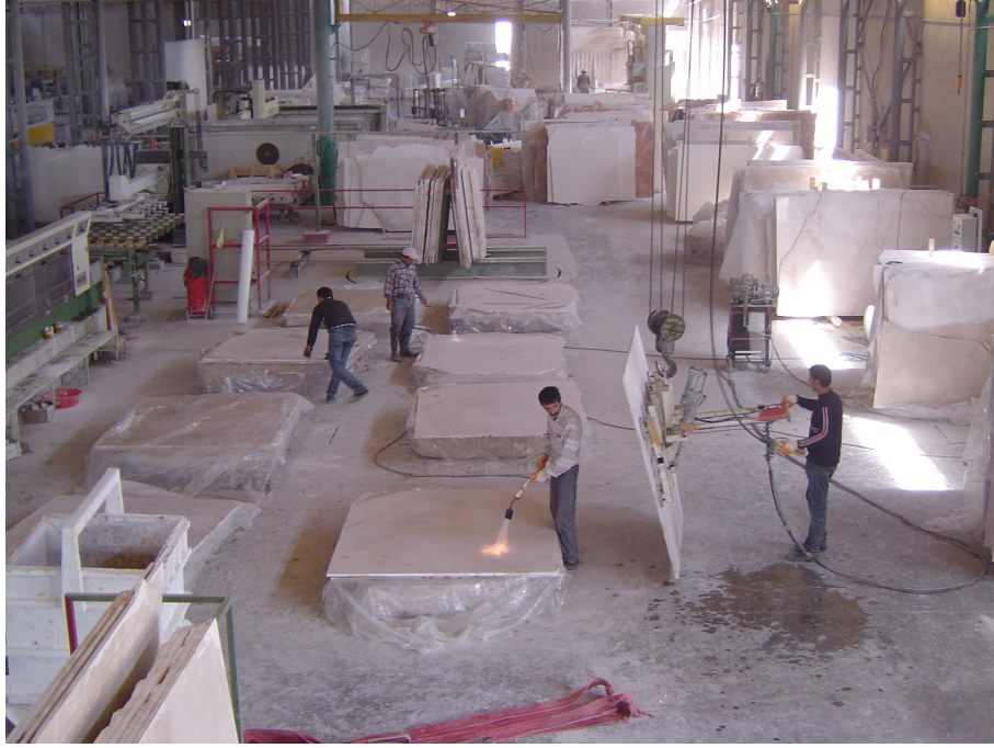
Şekil 2.5.1.4-1 Plaka epoksi uygulama ünitesi
