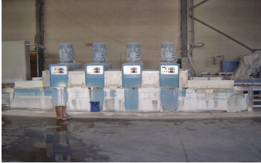
Şekil 2.5.2.4-1 Yerli yapım 4 kafalı kalibrasyon makinesi
