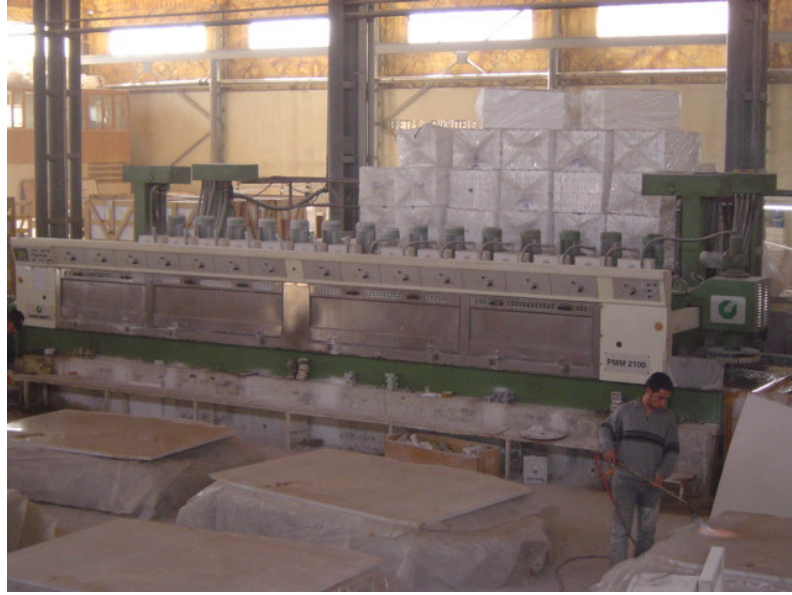
Şekil 2.5.1.2-1 Gaspari Menotti marka plaka cila makinesi
