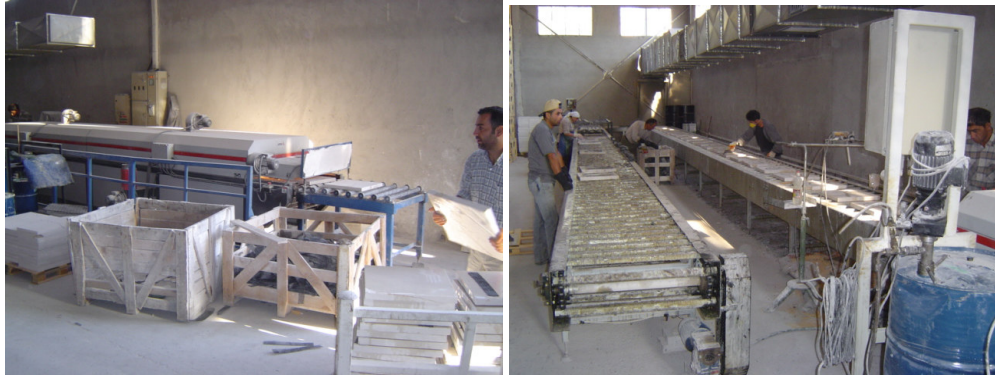
Şekil 2.5.2.2-1 Strip epoksi uygulama ünitesi IR tünel fırını
