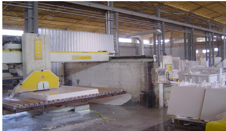
Şekil 2.5.1.3-1 GMM marka köprü kesme makinesi
