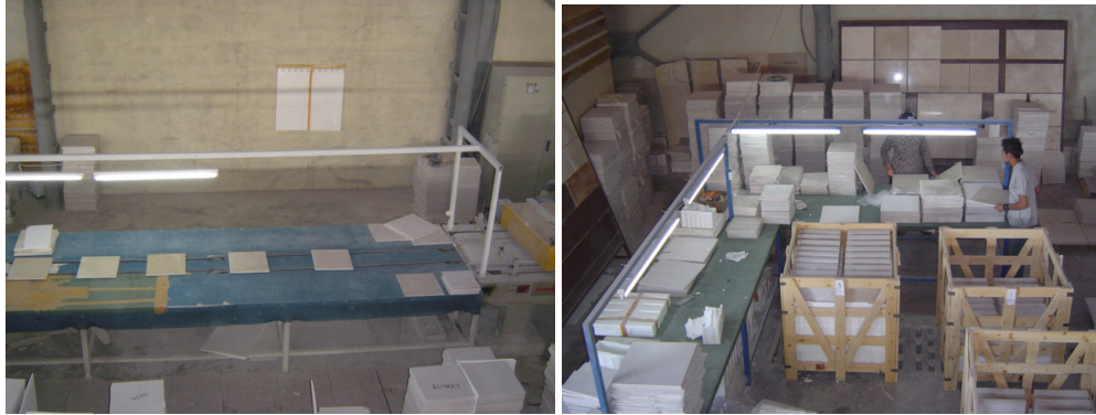
Şekil 2.5.2.8-2 Bitiş ünitesi seleksiyon masaları
