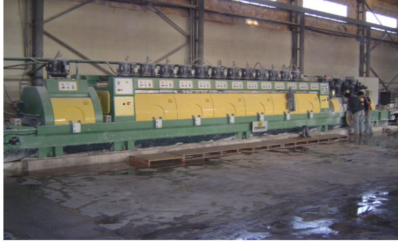
Şekil 2.5.2.5-1 Pedrini marka 3 + 12 + 1 fayans cila makinesi
