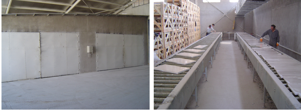
Şekil 2.5.2.2-2 Strip epoksi kurutma fırınları ve uygulama hattı
