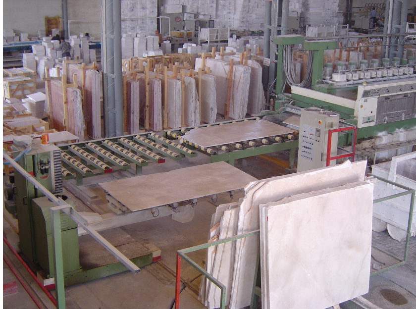
Şekil 2.5.1.2-2 Robot yükleme boşaltma sistemi
