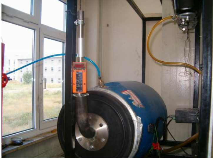
ekil 5.8 Hava akı metresinin motora ba lantısı.
