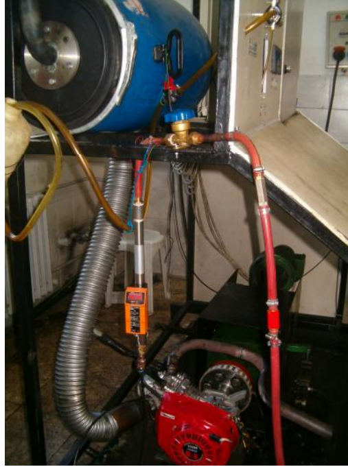
ekil 5.7 Hidrojen akı metrenin motora ba lantısı.
