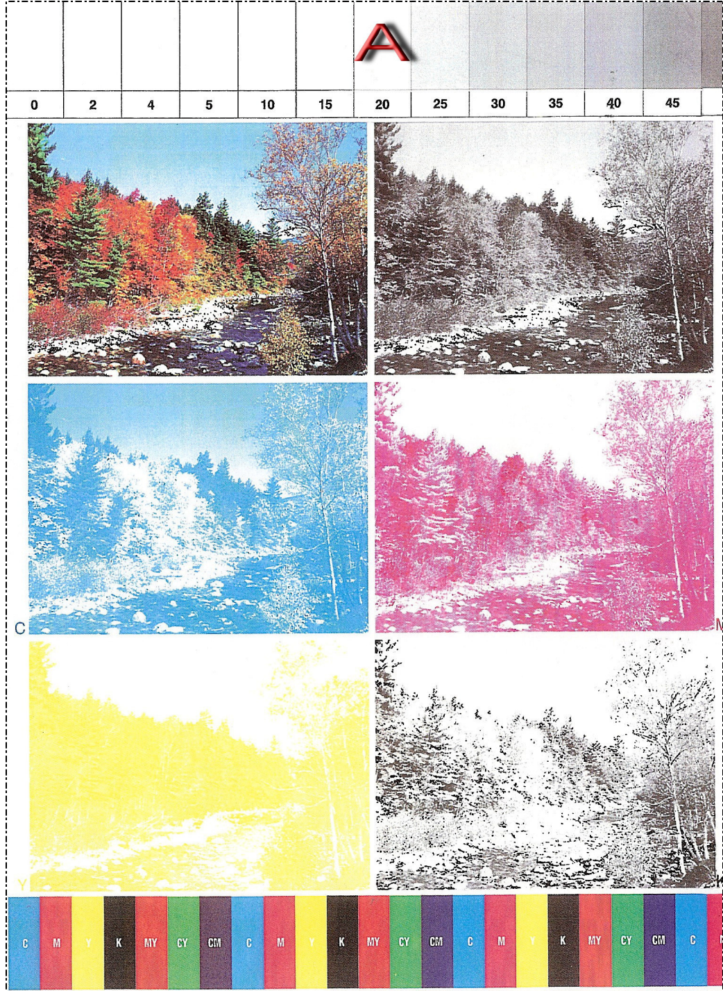
EK- 3 Alkol Nemlendirme Sistemli Roland 204 baskı makinesiyle basılan orijinalden taranan A 4 (A paftası)
