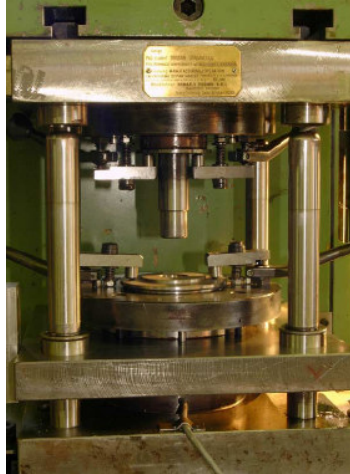
Şekil 5.3 Prese montajlı ekstrüzyon kalıbı (Tiernan, 2005).
