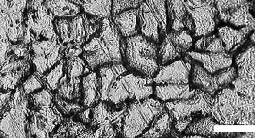
Şekil B.3 %1,9 Ekstrüze edilen numunelerin mikro yapı görüntüleri
