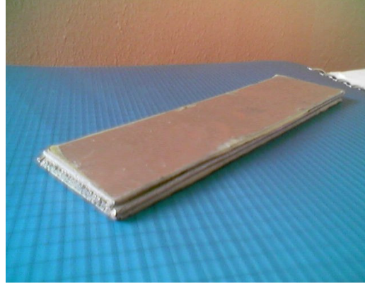
Şekil 3.2. Al matriksli ve çelik tel takviyeli kompozit malzeme
