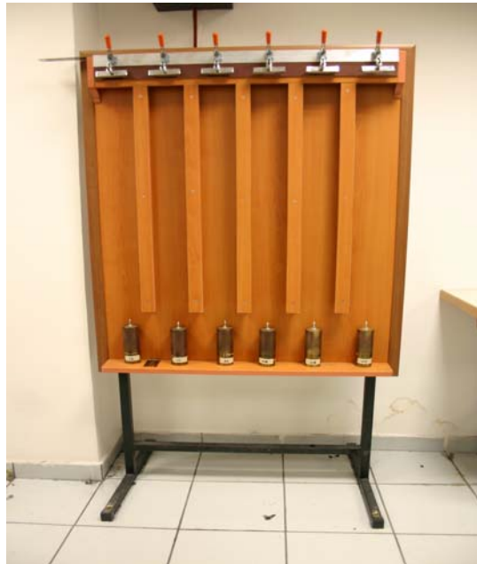
Şekil 4.2. Elastikiyet ve kalıcı uzama test aletinin görünümü
