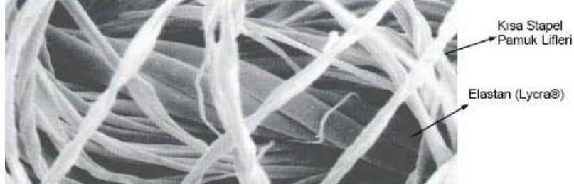
Şekil 2.20 Elastik core ipliğinin (44 dtex Lycra® / pamuk) mikroskop altında görünümü (x250)
