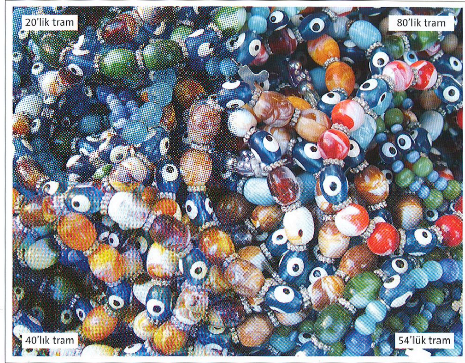
Şekil 6.26 Farklı tram değerlerinin baskıdaki görünüşü
