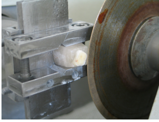
Resim 2.8. Aşındırıldıktan sonra Micracut kesit alma cihazına yerleştirilmiş örneğin görüntüsü.
