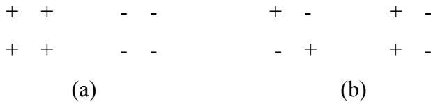
Şekil 2.8. Spin-1/2 Ising model için; a) ferromanyetik taban durum, b) antiferromanyetik taban durum.
