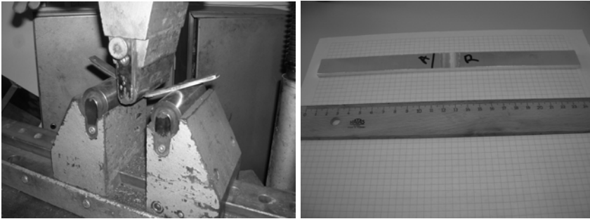
Şekil 3.6. : Eğme testi numuneleri ve uygulaması
