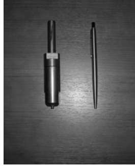
Şekil 3.1. : Sürtünme karıştırma aparatı
