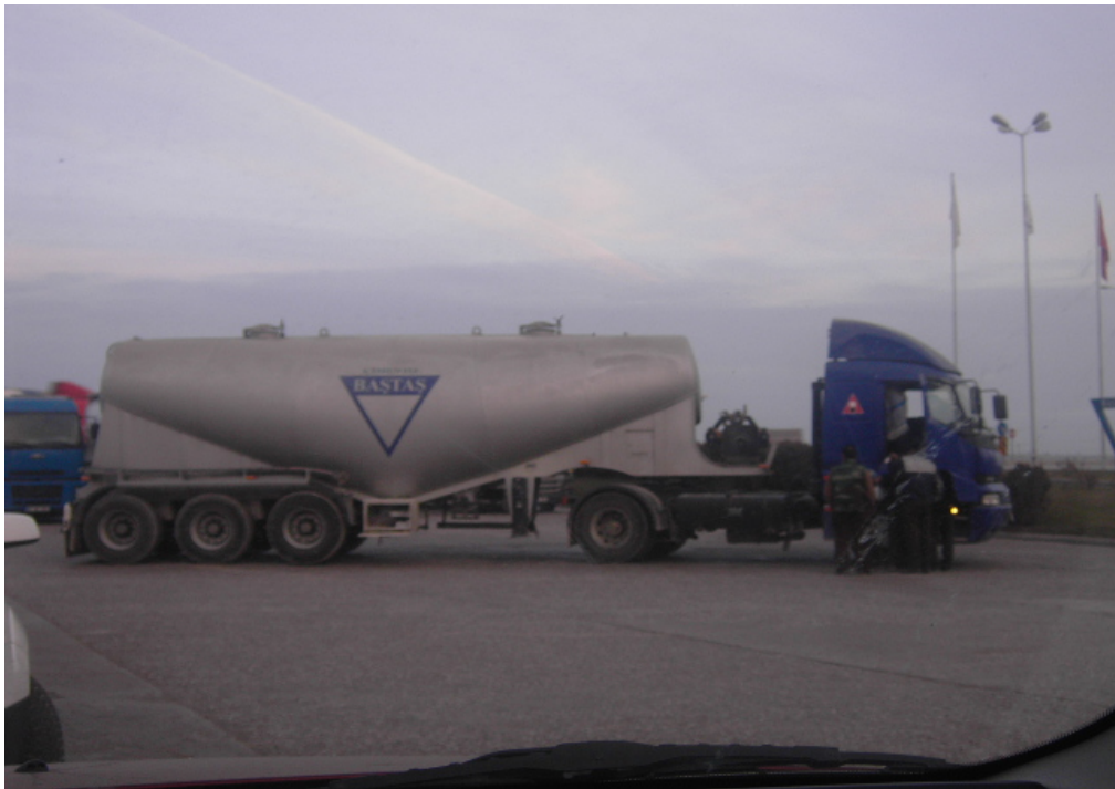
Resim 3.1. Özel donanımlı toz çimento nakliyesinde kullanılan silo tır
