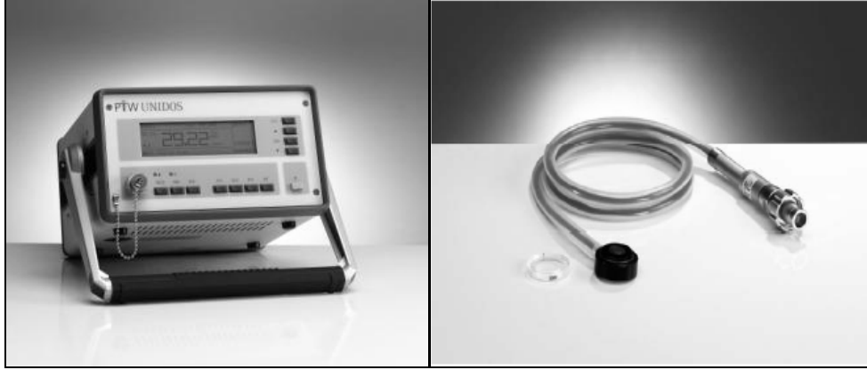
Şekil 3-1: PTW unidos dozimetre ve Markus paralel plan odası
